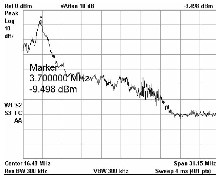
Figura 4.38 Ruido producido por Computador en la Frecuencia
