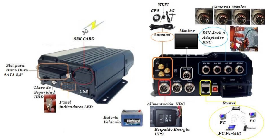
Figura 23: Diagrama de Conexiones del Sistema móvil de seguridad.
