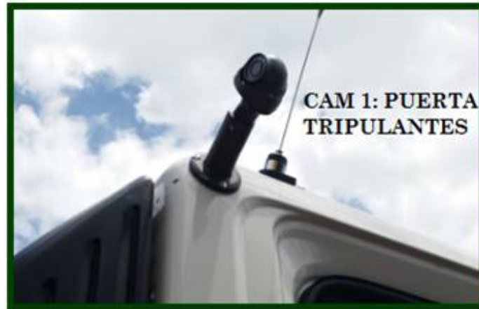
Figura 30: Cámara Lateral Blindado
