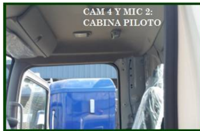
Figura 33: Cámara y Micrófono cabina piloto de Blindado.
