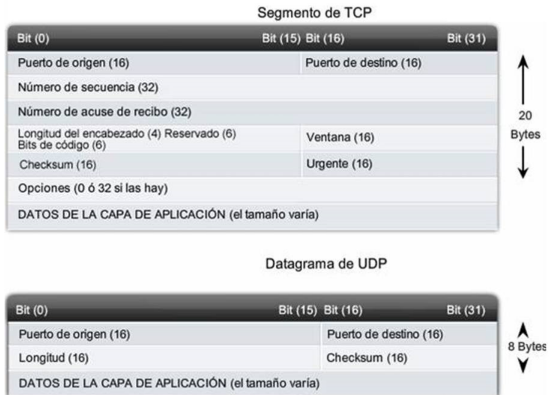
Figura 8: Encabezado Protocolos TCP y UDP.
