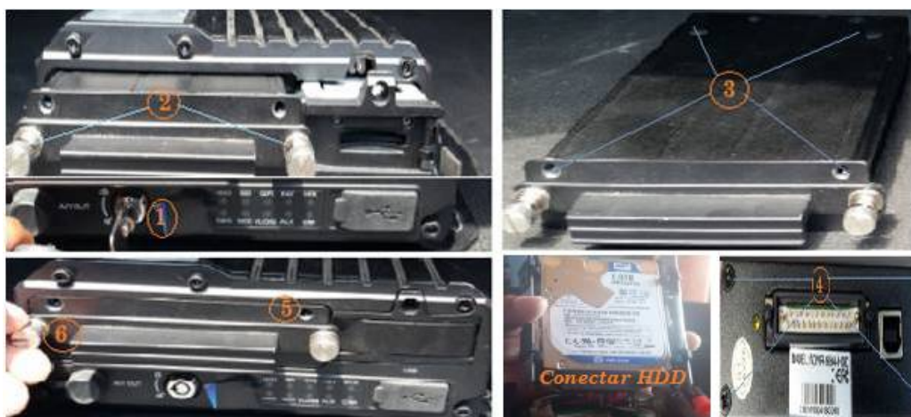
Figura 25: Instalación de Disco Duro SATA 2.5" en el MDVR 9804.
