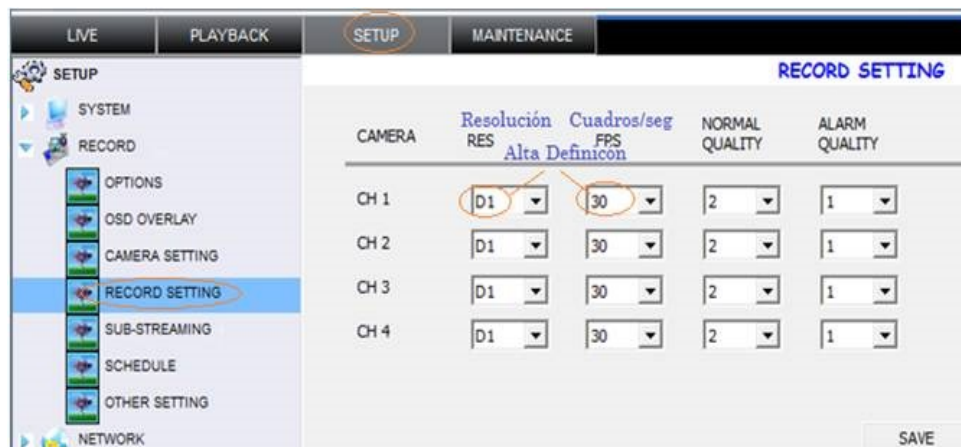
Figura 42: Configuración de Record MDVR, Flujo de Video - Disco Duro.
