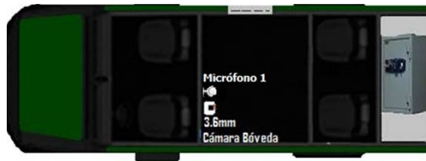
(a) Ubicación cámara Bóveda del blindado
