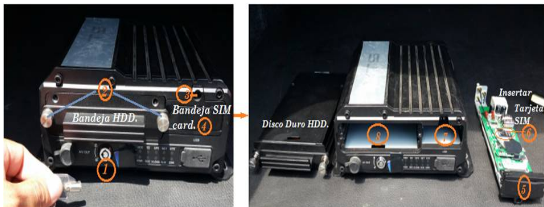
Figura 24: Instalación de la tarjeta SIM en el MDVR 9804.
