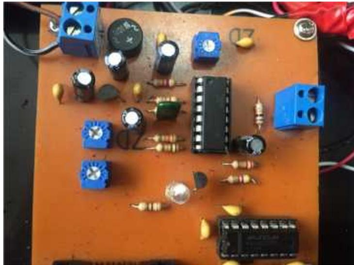
**Figura 99 Módulo de transmisión de datos.**
