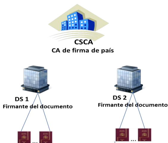
Figura 33. Estructura PKI recomendada por la OACI para la emisión de pasaportes electrónicos
