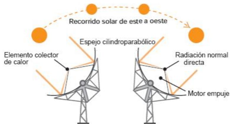
**Figura 4** Operación y trayectoria diaria de un concentrador solar parabólico
