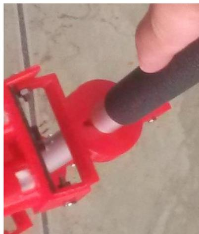
**Figura 33.** Impresión 3D de Acople entre Sensor y Bastón Blanco
