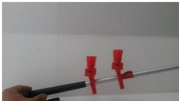
**Figura 35.** Impresión 3D de Cono para Sensor Ultrasónico
