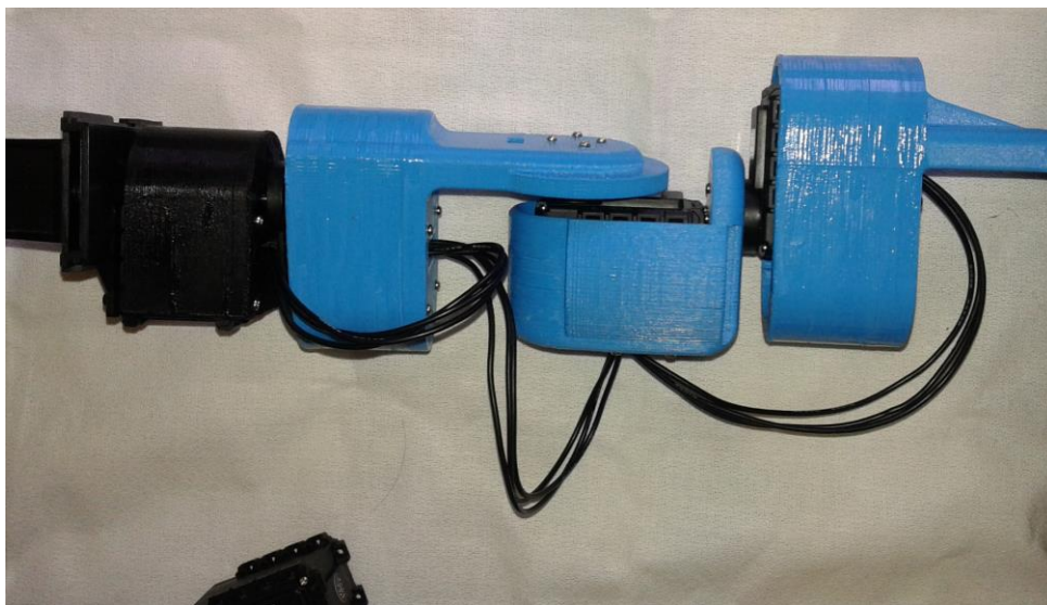
Figura 91. Quinto, sexto y séptimo eslabón ensamblado.
