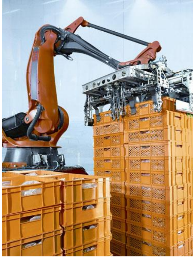
Figura 17. Robot KUKA en un sistema de paletización.
