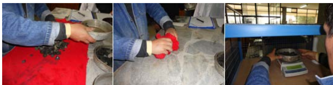
Figura 76. Ensayo de peso específico y absorción del árido grueso
