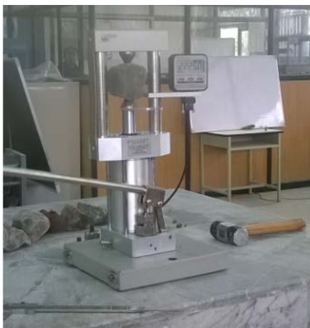
Figura 78. Ensayo de carga puntual
