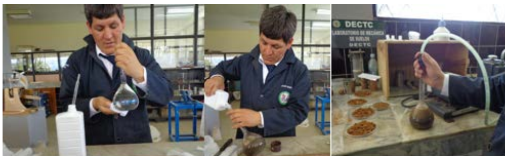
Figura 77. Ensayo de gravedad específica y absorción del árido fino
