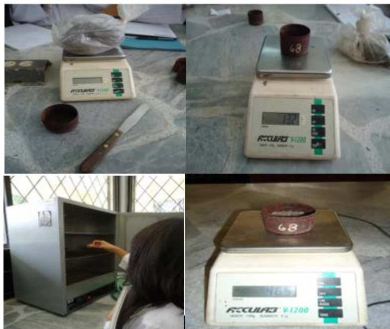
Figura 74. Ensayo de contenido de humedad
