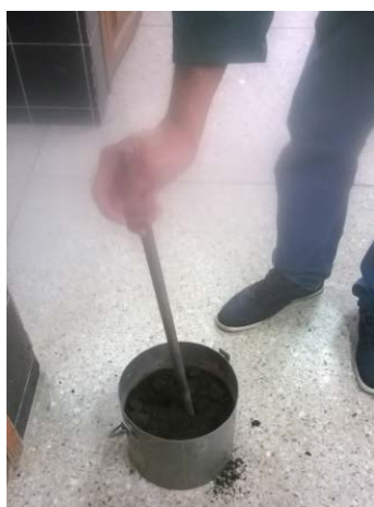
Figura 75. Ensayo de densidad varillada
