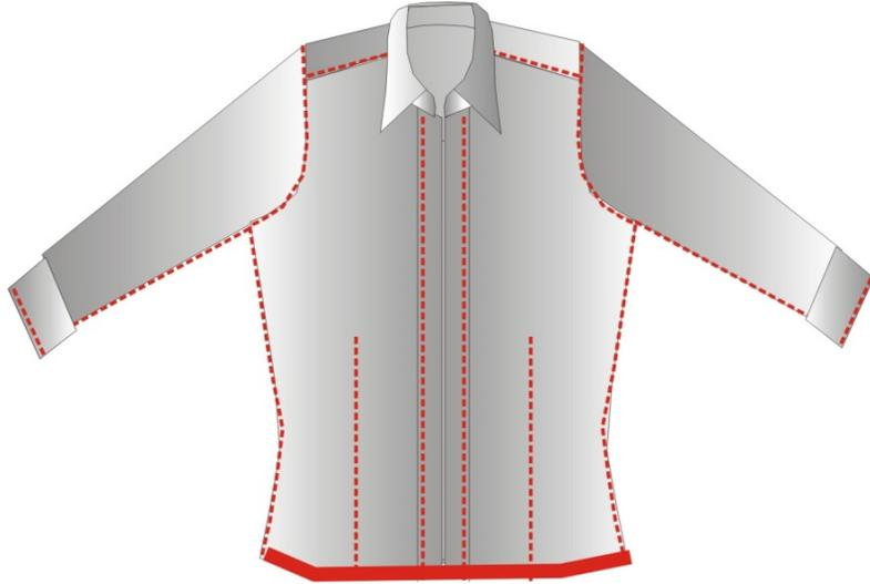
El doblado de la parte baja de la blusa se lo realiza con una maquina recta y un aditamento el cual permite determinar el ancho de este doblado, este aditamento se coloca en el pie de la maquina.
