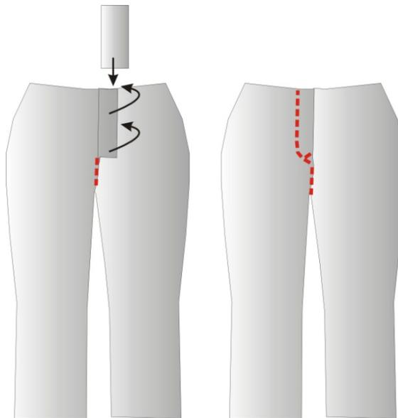
Para hacer la bragueta y pegar el cierre se necesita una maquina recta, se dobla el excedente de un delantero y se pega la pieza de bragueta en el otro al realizar esta actividad se pega el cierre y se realiza los pespuntos de la bragueta.
