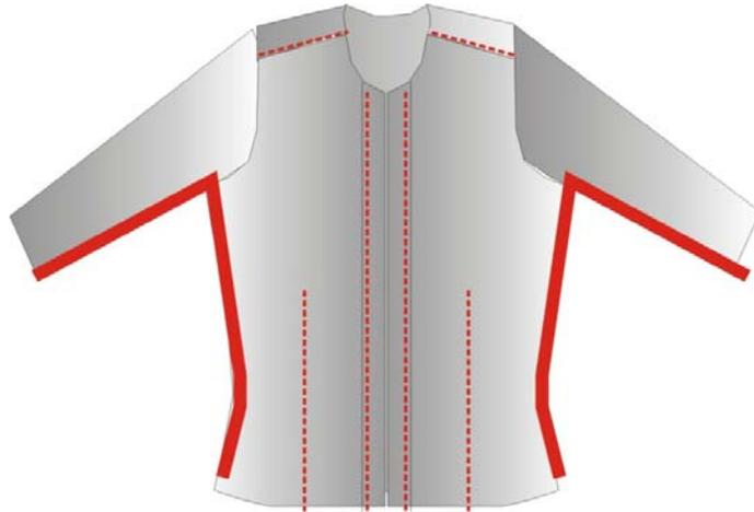
Con maquina overlock de 5 hilos o cerradura de codo, se cosen los laterales del cuerpo y las mangas, como se muestra en la figura
