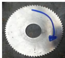
**Figura 65. Giro correcto de la cuchilla circular dentada**
