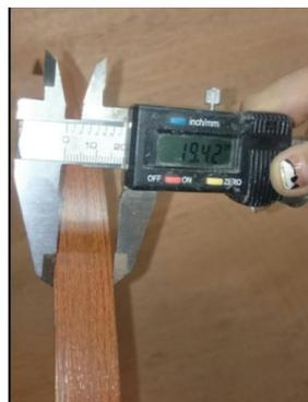
**Figura 74. Medida del corte a 19 mm**
