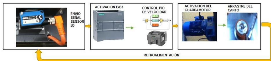
**Figura 63. Diagrama bloques activación del motor M2 (arrastre)**
