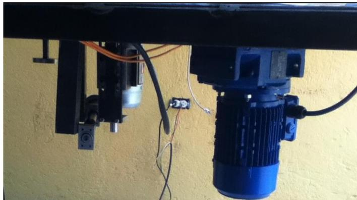
**Figura 55. Motor y Guardamotor**
