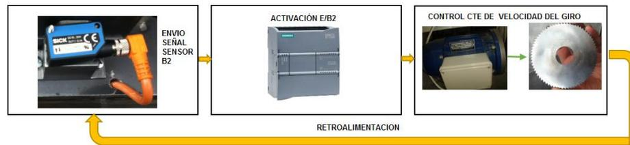
**Figura 62. Diagrama bloques activación del motor M1 (cuchilla)**
