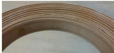
**Figura 64. Resultado de la posición errónea de la cuchilla**
