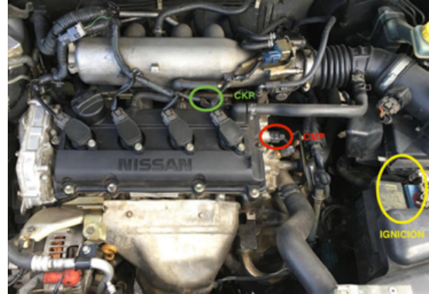
Figura 1 Ubicación de los sensores e ignición
