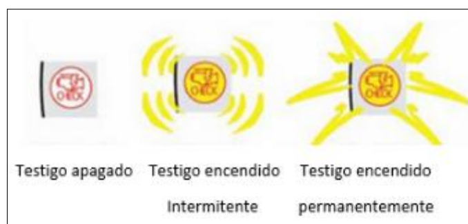
Figura 9 Representación esquemática del proceso de iluminación del testigo Fuente (Gonzales C, 2012)
