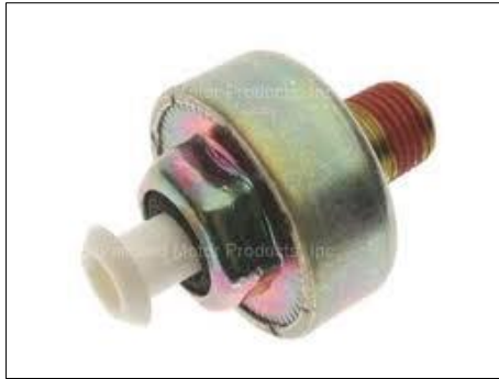
Figura 16 Sensor de detonación. Fuente: (Ocaño, 2013)
