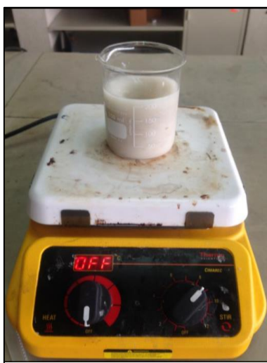
Figura 28. Lavado por agitación
