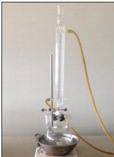
Figura 17. Sistema de enfriamiento por reflujo
