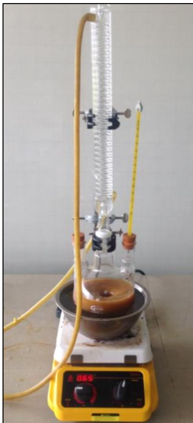
Figura 24. Reactor agitado y refrigerado
