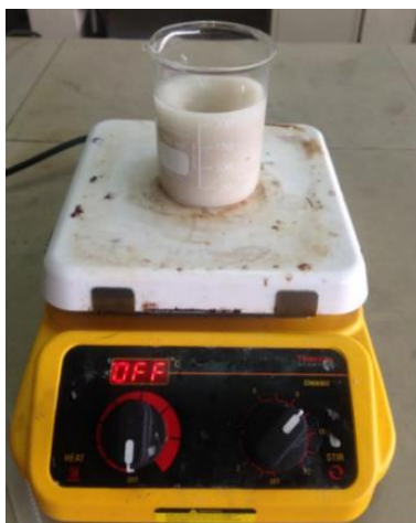
Figura 23. Agitación del metóxido
