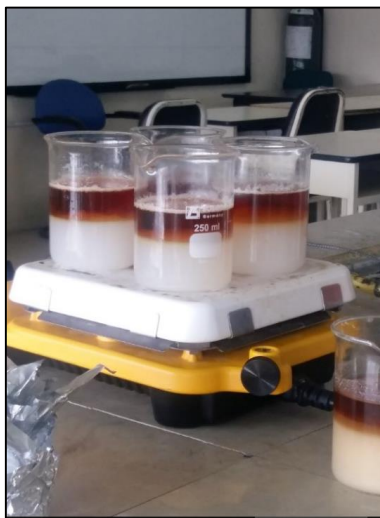
Figura 27. Lavado de biodiesel (agua-biodiesel)
