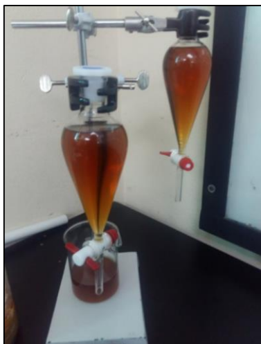
Figura 30. Separación de productos
