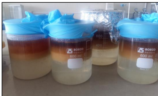
Figura 29. Almacenamiento de biodiesel lavado
