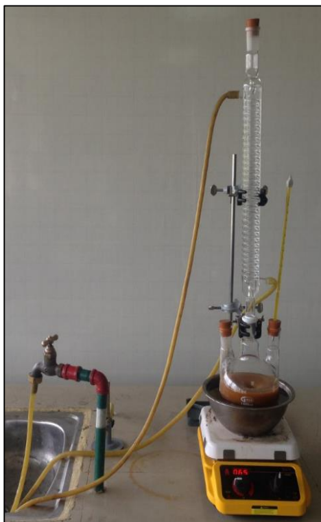
Figura 19. Reactor agitado en funcionamiento
