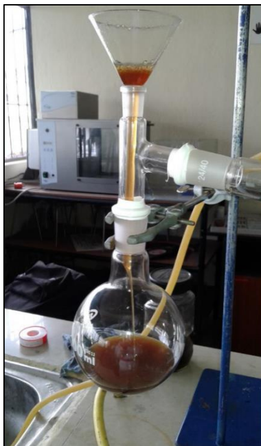
Figura 20. Incorporación de aceite usado en el reactor
