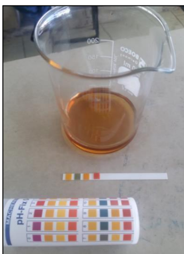
Figura 32. Medición del pH del agua de lavado
