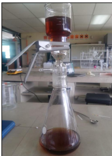
Figura 26. Filtrado del catalizador
