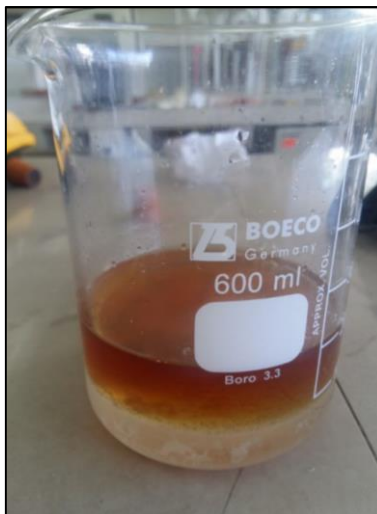
Figura 31. Separación de biodiesel del agua de lavado
