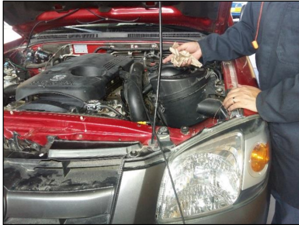
Figura 45. Colocación de la sonda de temperatura
