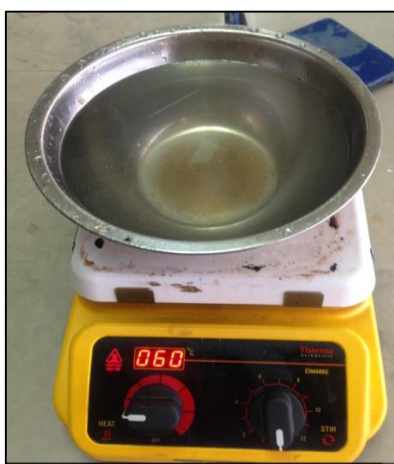
Figura 18. Sistema de calefacción por baño maría
