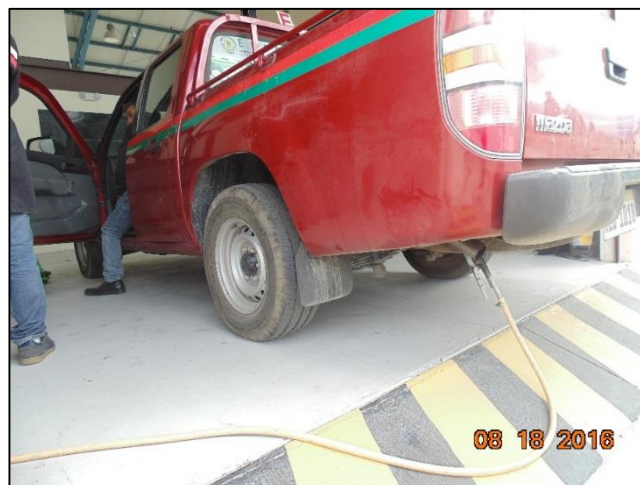
Figura 4.1: Colocación de la sonda en el tubo de escape
