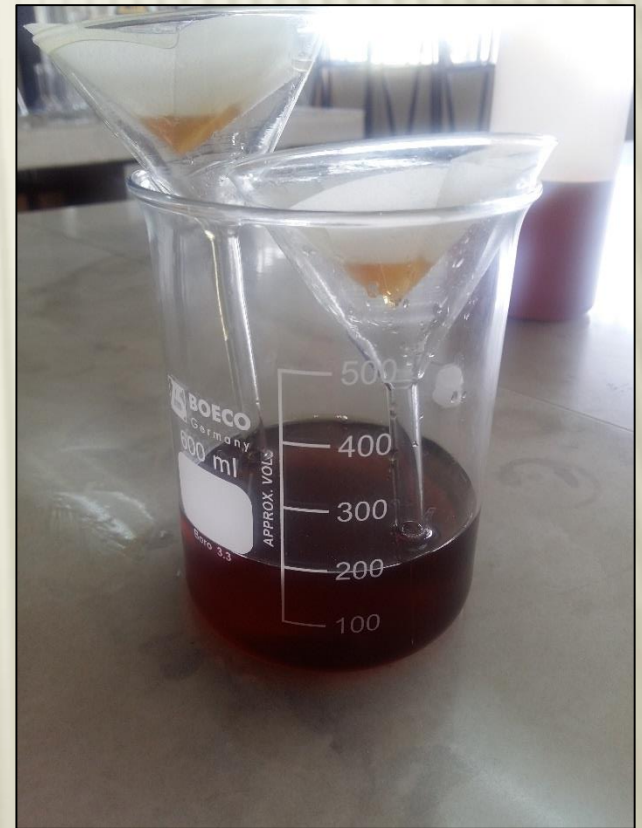
Filtración del biodiesel
