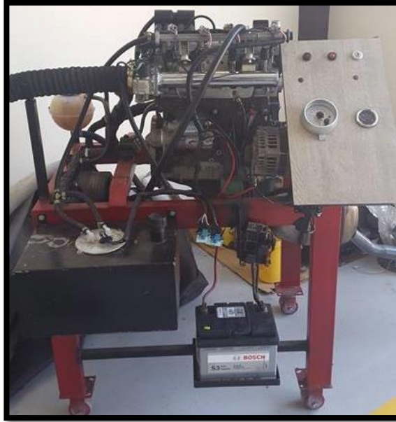
Figura 20. Puesta a Punto motor FIAT FIRE EVO 1400CC
