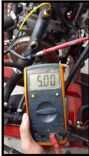
Figura 102 Voltaje de referencia sensor ECT
