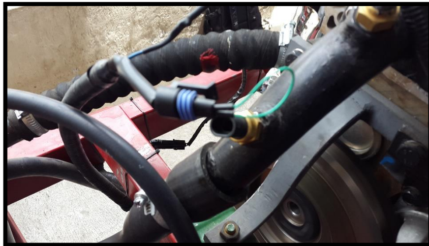
Figura 43 Generación DTC en código bajo en sensor ECT
