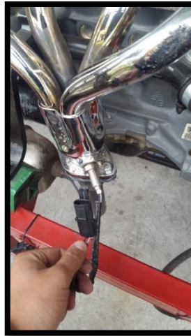
Figura 90 Sensor de oxígeno desconectado (Genera DTC alto)
