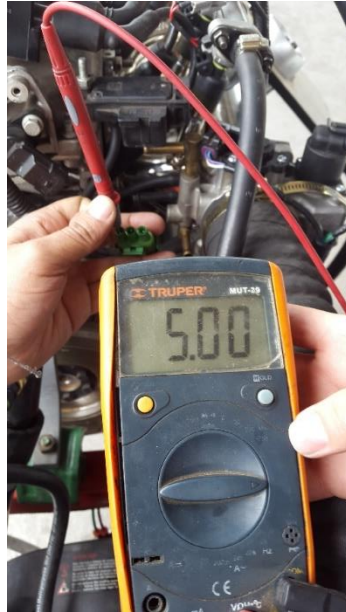
Figura 32 Voltaje de referencia sensor MAP
