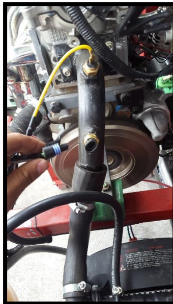
Figura 41 Generación DTC en código alto en Sensor ECT.
