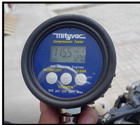
Figura 36 Valor de la compresión en el cilindro #2
