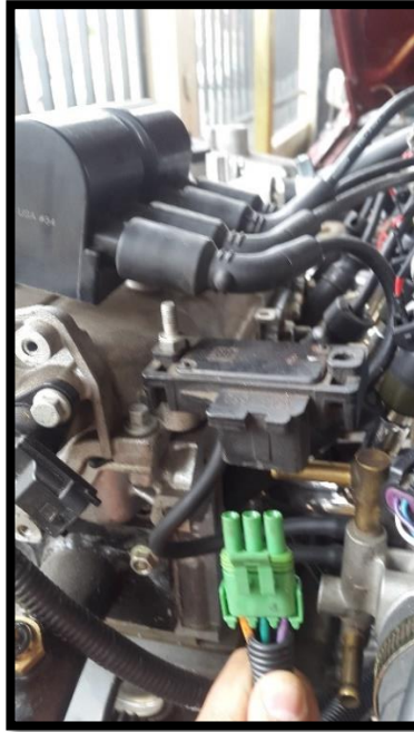
Figura 42 Generación DTC en código bajo en sensor MAP.
