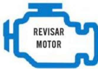
Figura 2 Símbolo de la lámpara MIL del cuadro de mando que indica un mal funcionamiento a través de OBD Fuente: (Cano, 2012).
