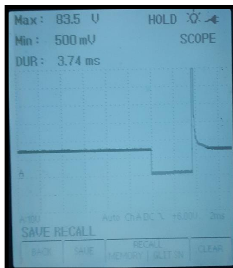
Figura 50 Oscilograma del inyector 2 cuando se genera DTC alto en ECT y DTC bajo sensor de Oxígeno 1000 rpm
