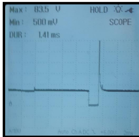
Figura 100 Oscilograma del tiempo de inyección a 3000 r.p.m cuando se presenta DTC bajo en el sensor ECT (inyector #1)
