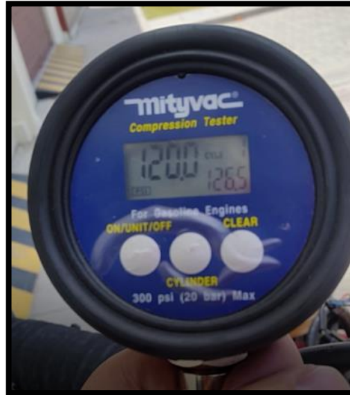
Figura 35 Valor de la compresión en el cilindro #1
