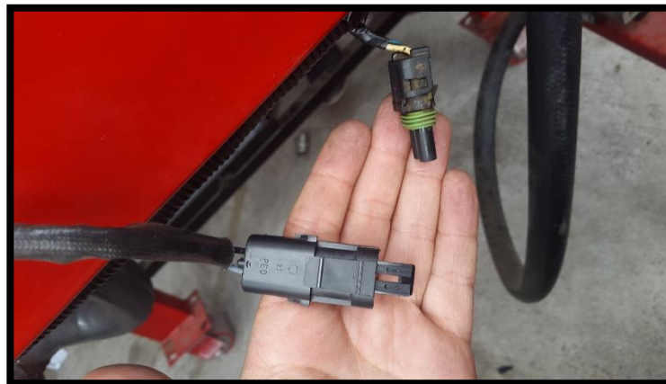
Figura 39 Generación DTC en código alto en Sensor de Oxígeno
