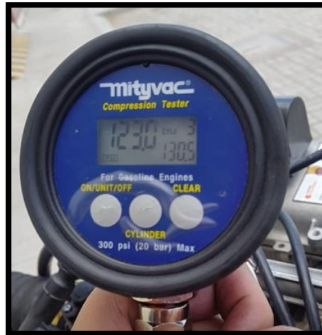
Figura 37 Valor de la compresión en el cilindro #3
