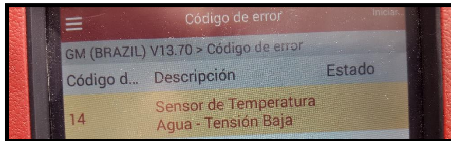
Figura 97 Reconocimiento del DTC del sensor ECT en código bajo
