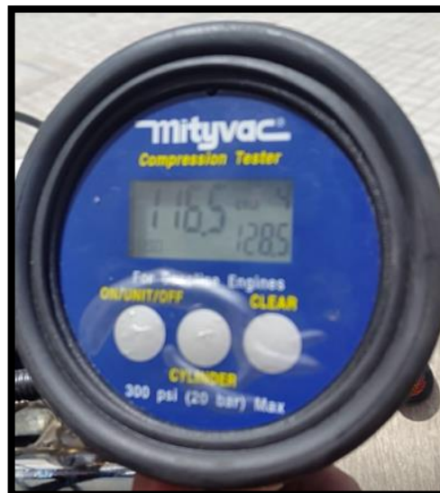
Figura 38 Valor de la compresión en el cilindro #4
