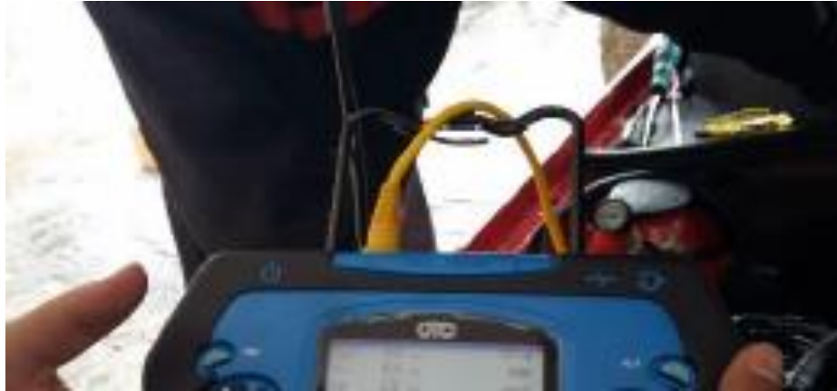
Figura 127 Punta de medición del osciloscopio (Color amarillo) en el canal A
