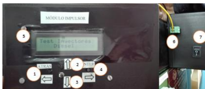
Figura No. 53. Panel de control modulo impulsor
