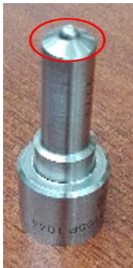
Figura No. 111. Sección de la tobera analizada con el microscopio
