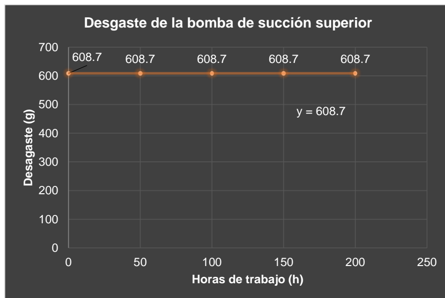
Figura No. 70. Desgaste de la bomba de succión superior
