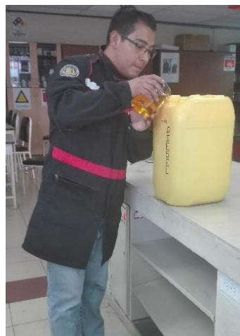
Figura No. 39. Preparación de la mezcla combustible B5
