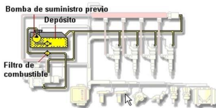
Figura No. 27. Sistema de baja presión
