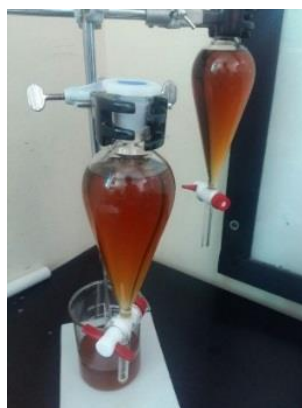
Figura No. 34. Proceso de separación del biodiesel
