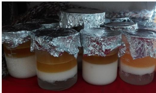
Figura No. 35. Proceso de lavado del biodiesel
