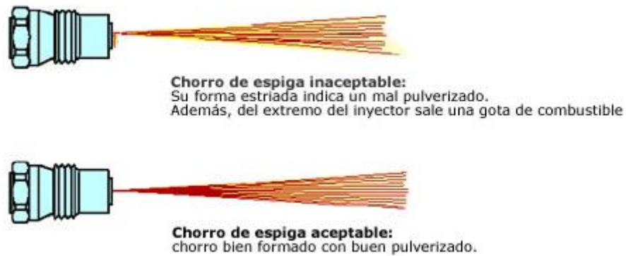
Figura No. 30. Forma de chorro de los inyectores
