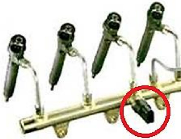
Figura No. 8. Sensor de presión del riel estructura
