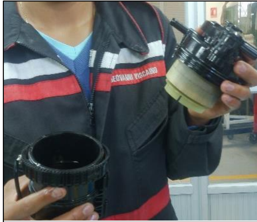
Figura 38. Inspección de filtro de combustible diésel.
