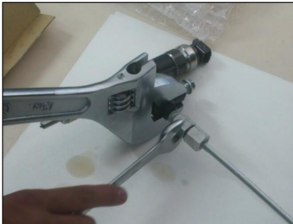
Figura 50. Extracción conducto de alta presión.
