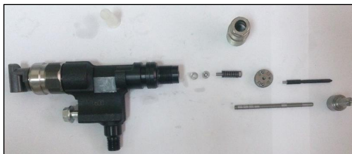
Figura 73. Extracción de elementos internos.
