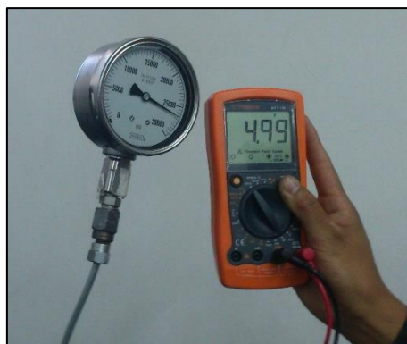
Figura 44. Voltajes de operación sensor de presión de riel.
