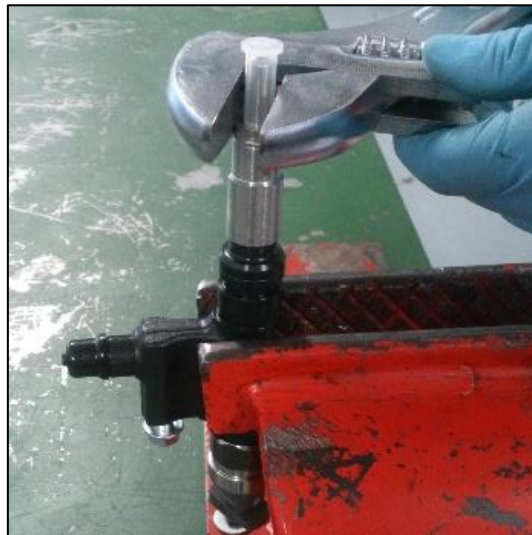
Figura 58. Proceso de desarmado de la tobera.
