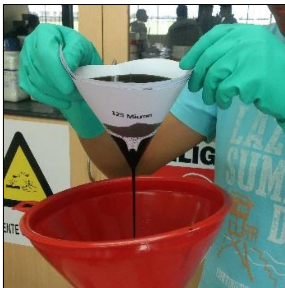
Figura 32. Filtración de aceite.
