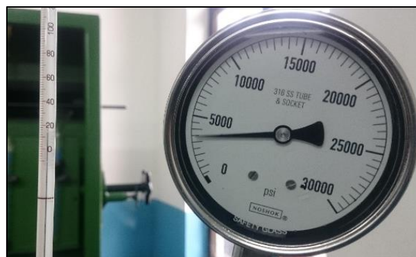
Figura 47. Manómetro de presión hidráulica lleno de glicerina.
