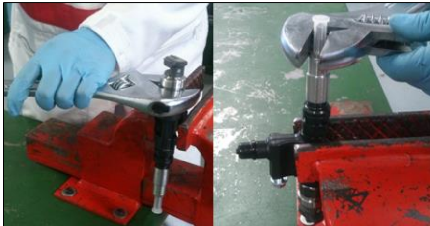
Figura 72. Desmontaje de elementos internos del inyector denso 6521.
