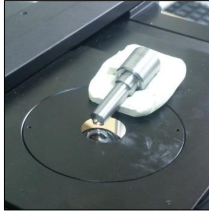
Figura 66. Molde de descanso para porta tobera.
