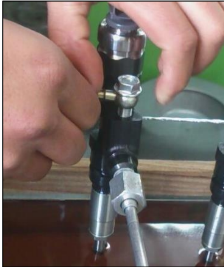
Figura 49. Extracción del conducto de retorno de diésel.
