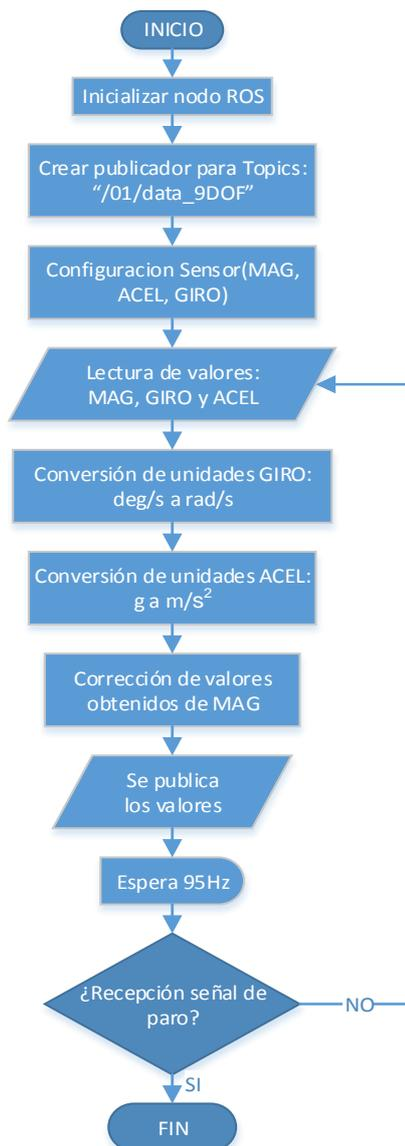
**Figura 105 Algoritmo de adquisición de datos**
