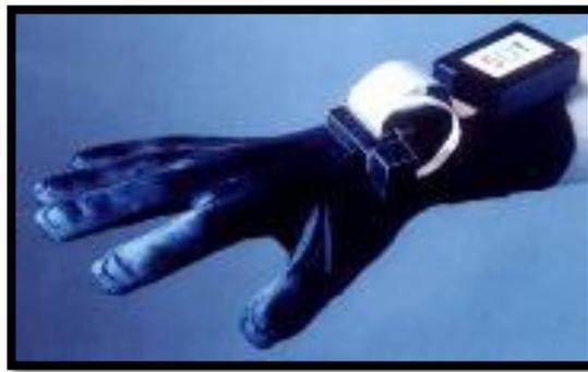
**Figura 21 Guante de fibra óptica**
