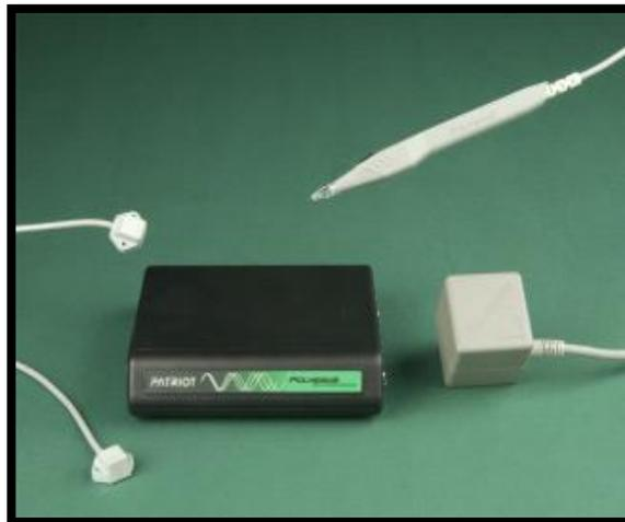
**Figura 19 Sensores y rastreadores electromagnéticos**
