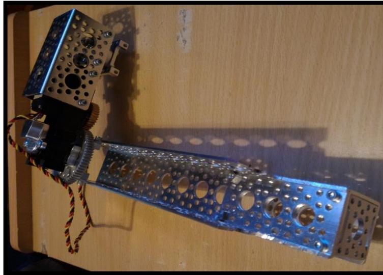
**Figura 72 Ensamble codo**
