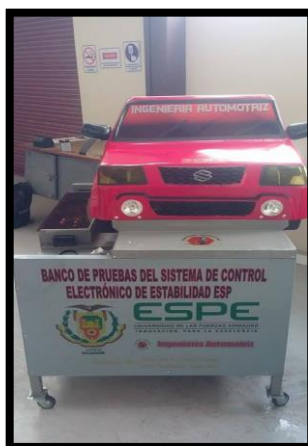
Figura 58 Banco de pruebas para sistema ESP
