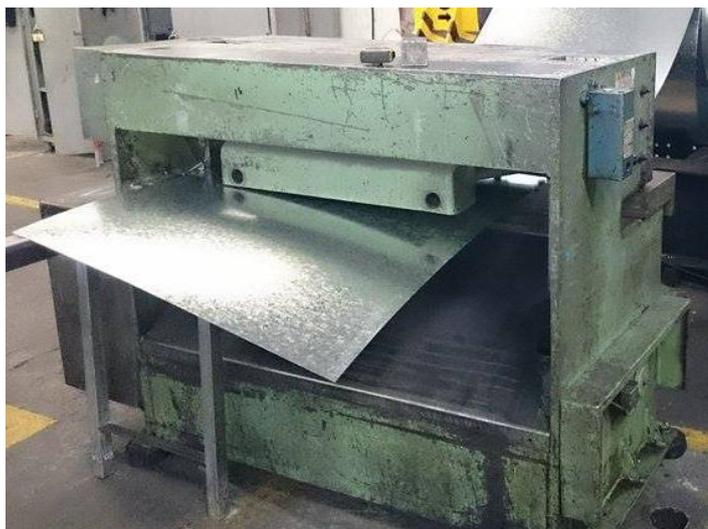
**Figura 5 Cizalla de guillotina**
