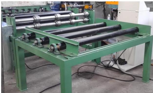
**Figura 49 Ensamblaje sistema de guiado y arrastre**
