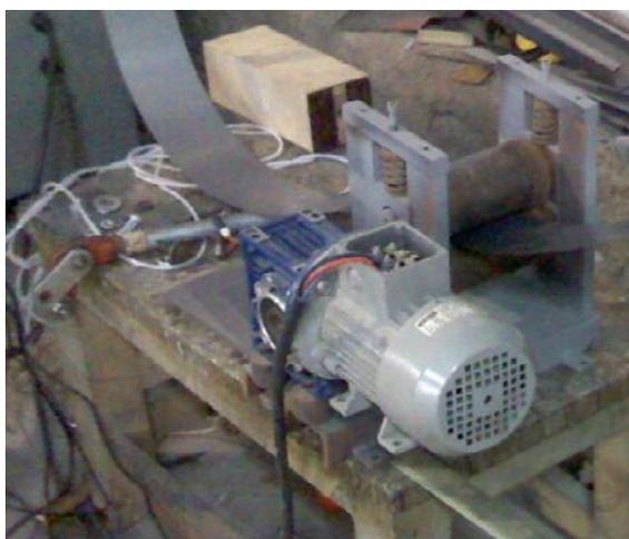
**Figura 2 Rodillos para la parte de alineación**
