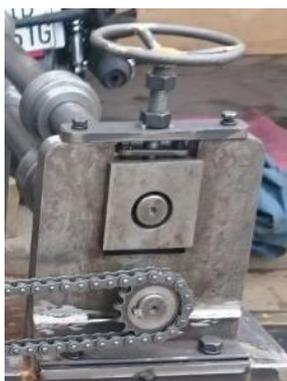
**Figura 45 Ensamblaje lateral fijo y móvil, con volante y soportes**
