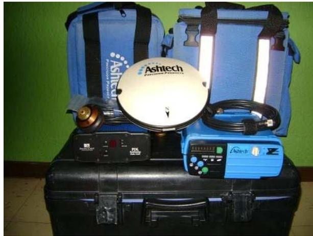
Figura 6.- GPS Doble Frecuencia Marca Astech Modelo Z-Xtreme
