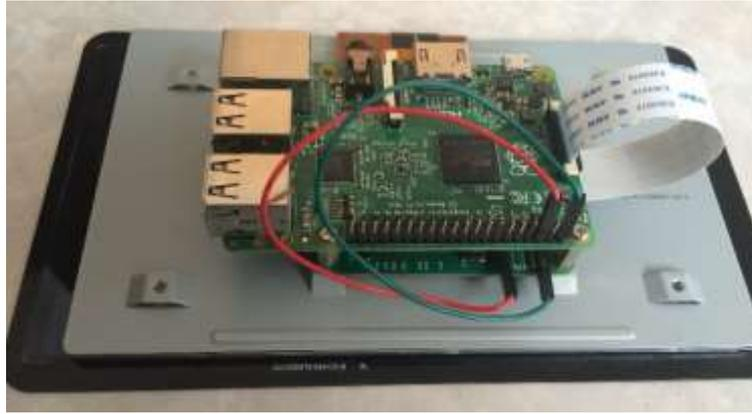
*Figura 32: Conexión de la Raspberry Pi con la pantalla táctil*
