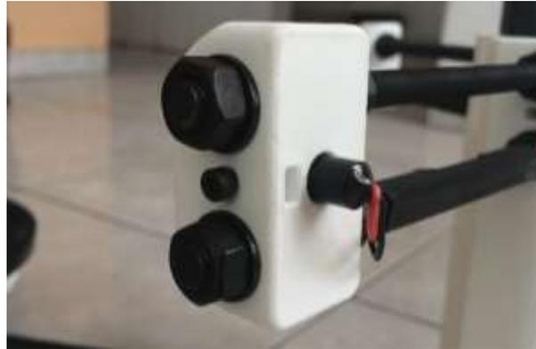
*Figura 29: Perno M3 para ajuste del laser*
