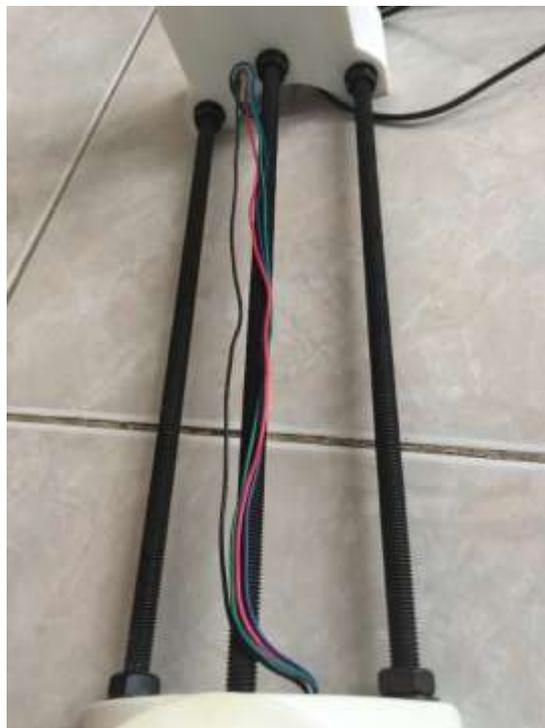
*Figura 30: Varillas roscadas para unión del pedestal con la mesa giratoria*
