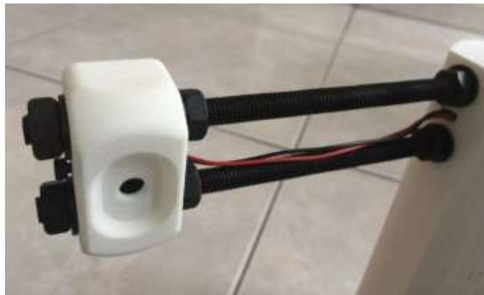
*Figura 28: Soporte de laser ensamblado en el pedestal*
