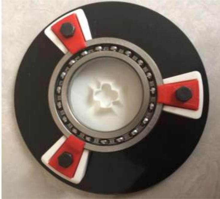
*Figura 23: Ensamble del disco de metacrilato con la base de disco*
