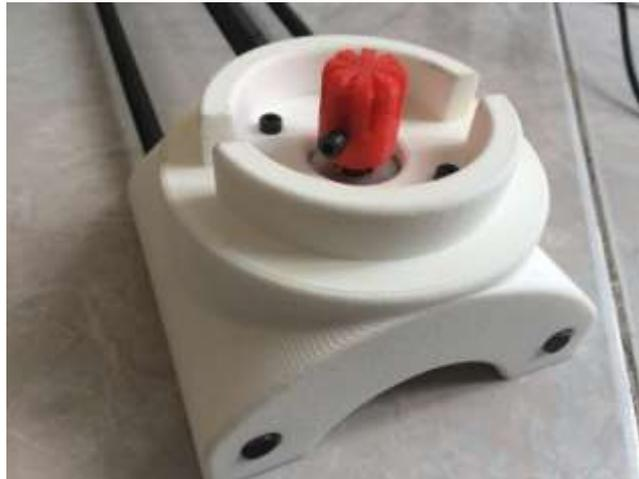
*Figura 25: Base de la mesa giratoria con el motor a pasos y el acople de forma*
