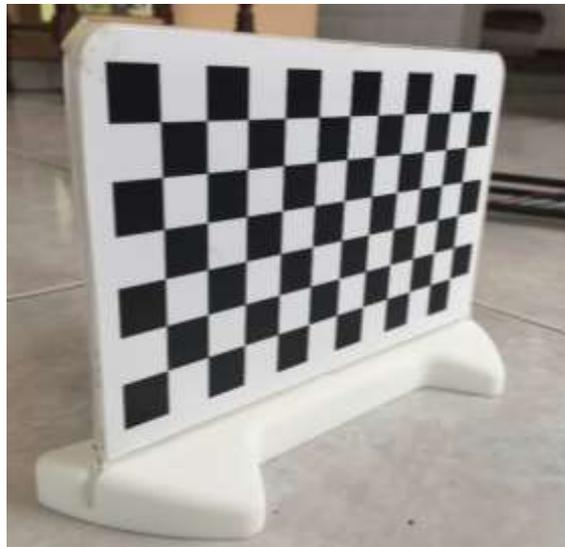
*Figura 31: Calibrador de la cámara*
