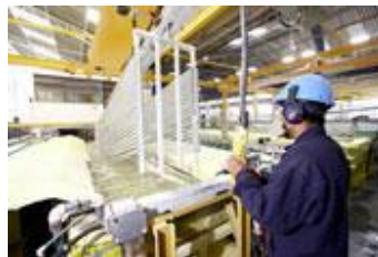
Figura 5 Tanque Natural, proceso de anodizado.
