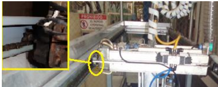
Figura 59 Mecanismo piñón – cadena.
