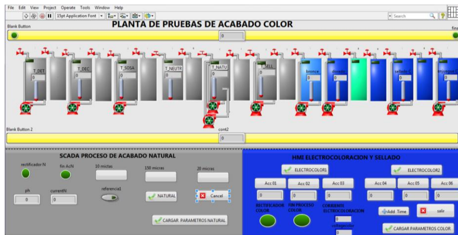
Figura 92 Hmi planta de pruebas de acabados de color
