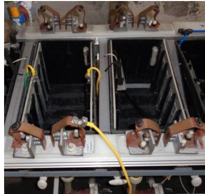
Figura 53 Ensamble de dedos de contacto en las cubas 13, 14.
