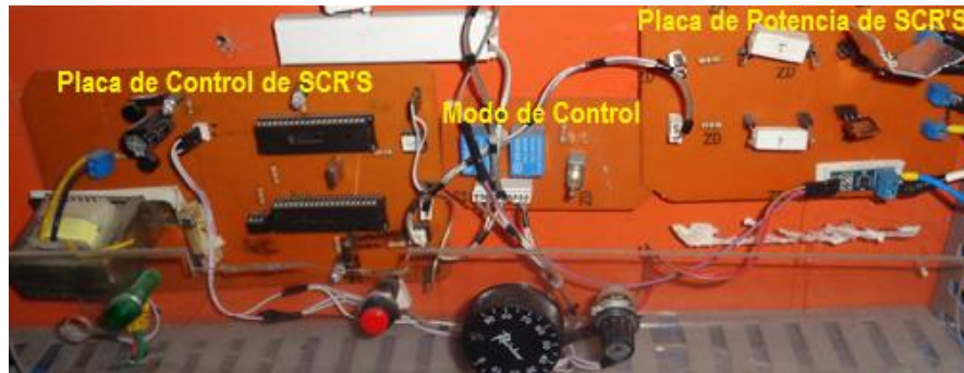
Figura 64 Tarjeta de disparo de SRC'S.
