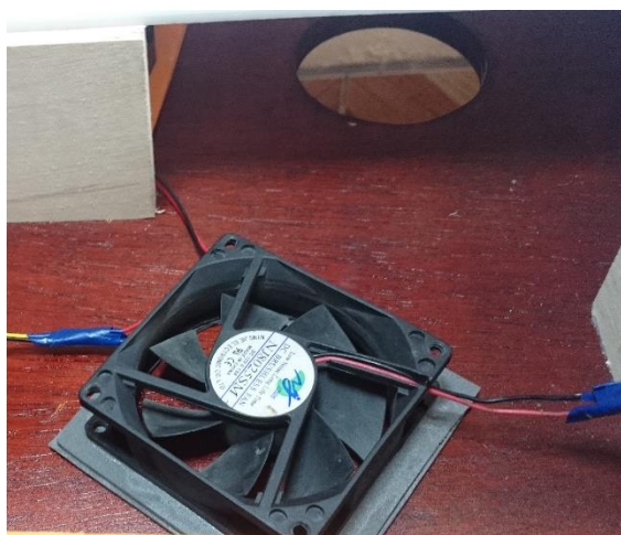
Figura 86 Montaje de ventiladores
