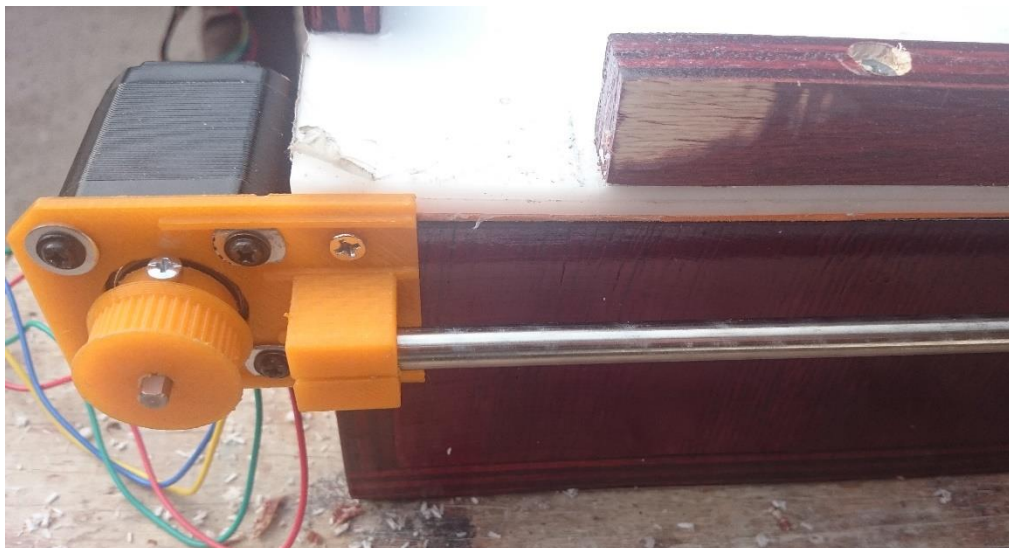
Figura 80 Fijación de los motores para el eje Y
