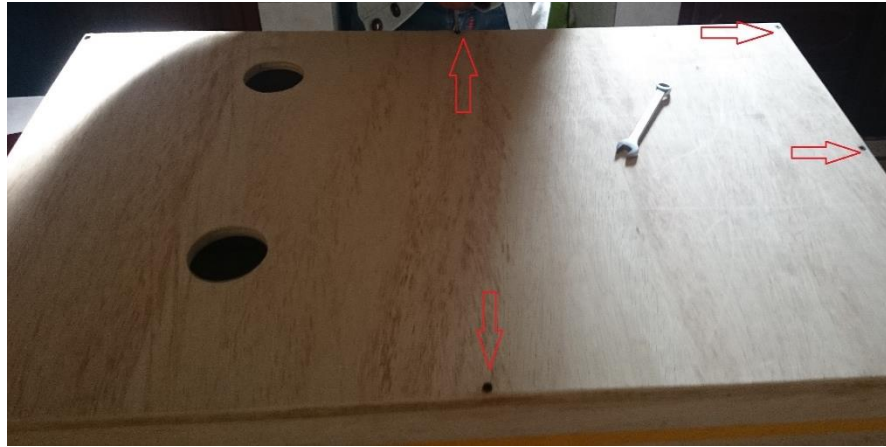
Figura 69 Refuerzo central posterior mediante tornillos 3x30mm
