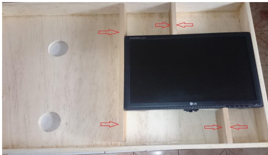
Figura 70 Colocación de apoyos para el monitor
