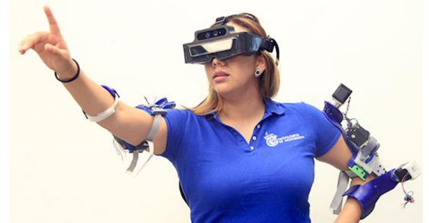
Exoesqueleto con visor de realidad aumentada para rehabilitación - INDI y WeaRobot, apoyadas por el ITESM, Mexico
