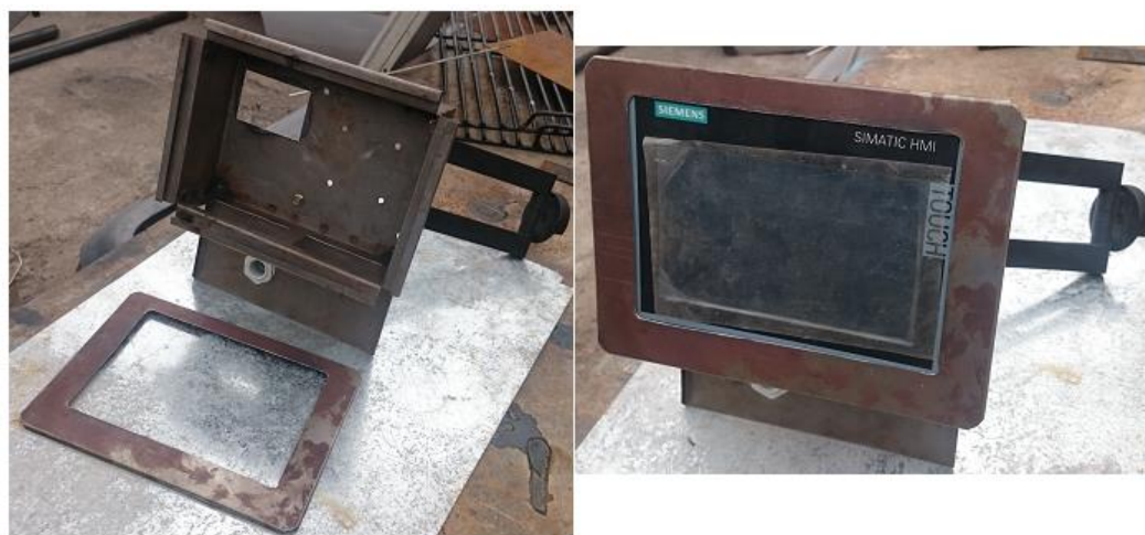
Figura 85.- Construcción soporte panel HMI.
