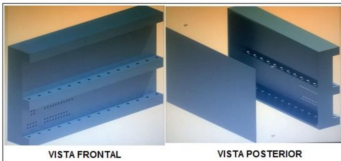
Figura 50 Diseño del tablero eléctrico a construir.
