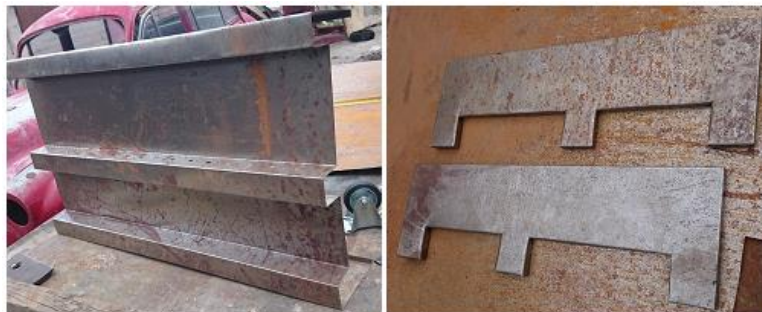
Figura 82.- Tablero eléctrico luego del proceso de doblado.
