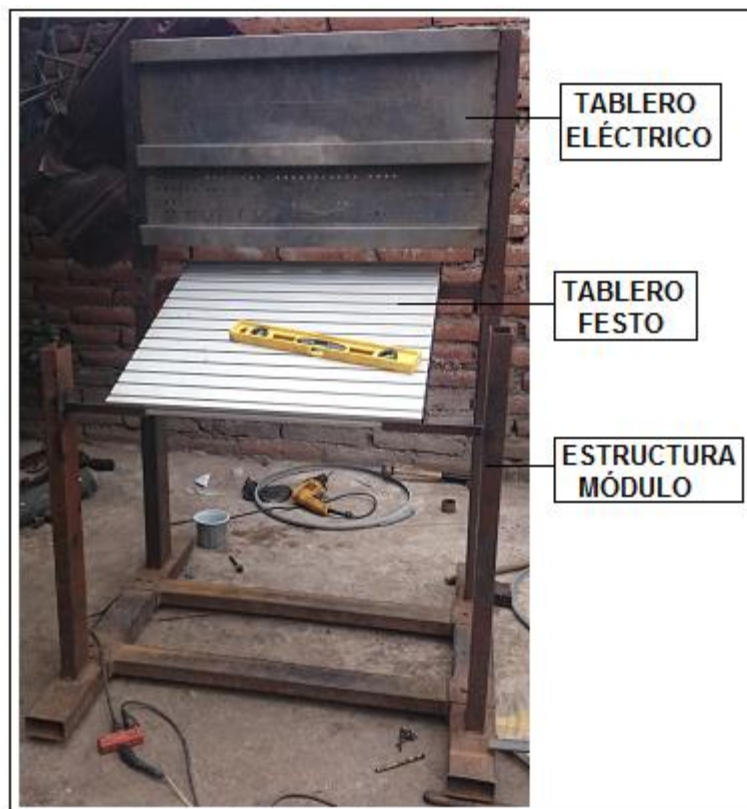
Figura 83.- Instalación del tablero eléctrico en la estructura del módulo.
