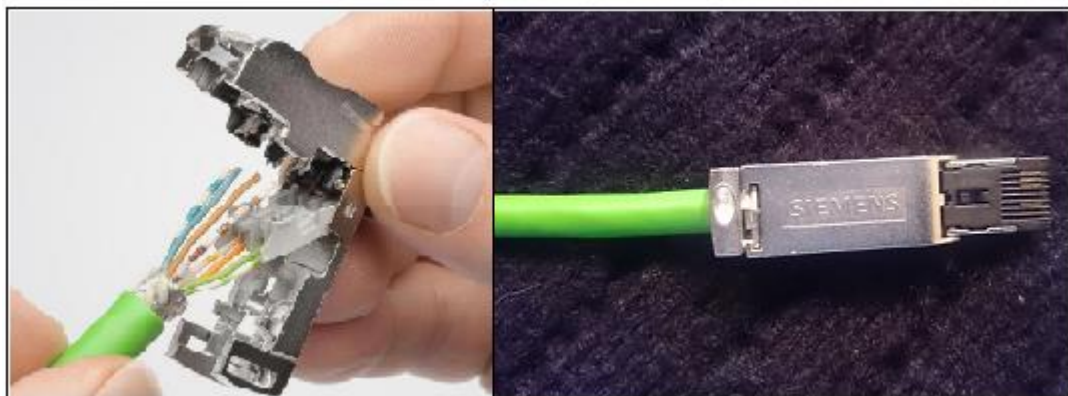
Figura 92.- Ensamble Cable para conexión Profinet.
