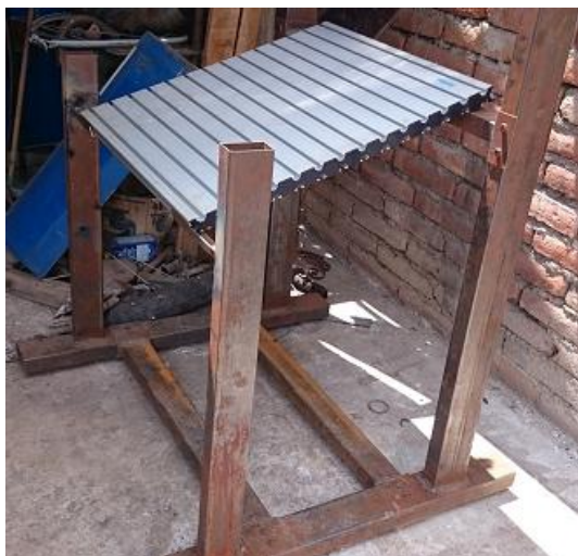
Figura 79 Sujeción del tablero FESTO.
