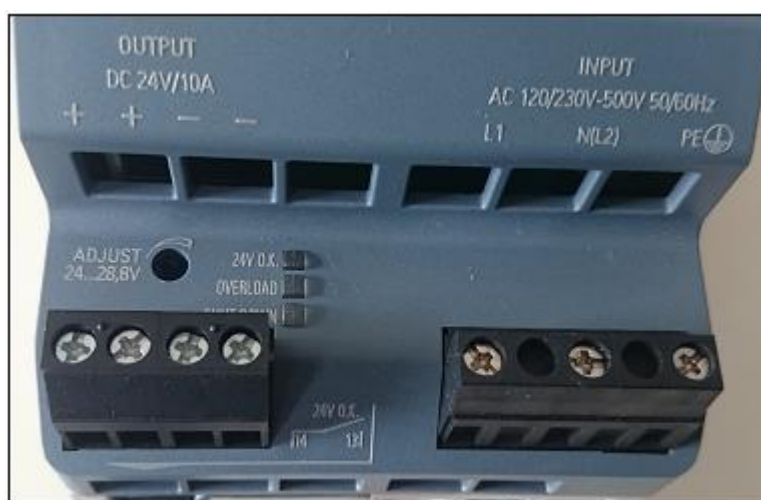
Figura 58 Pines de Conexión SITOP PSU100S 24 V/10 A
