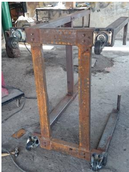
Figura 80.- Implementación de ruedas para desplazamiento.
