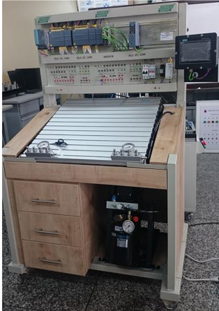
Figura 95.- Módulo de red Profinet terminado.
