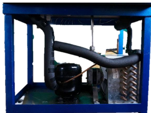
Figura 53 Sistema de refrigeración parte inferior.
