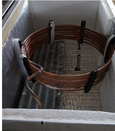
Figura 52 Sistema de refrigeración, parte superior.
