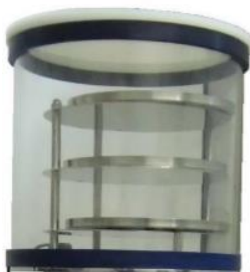
Figura 36 Cámara de secado.
