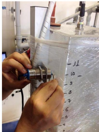
**Figura.83: Ubicación e de los sensores capacitivos.**
