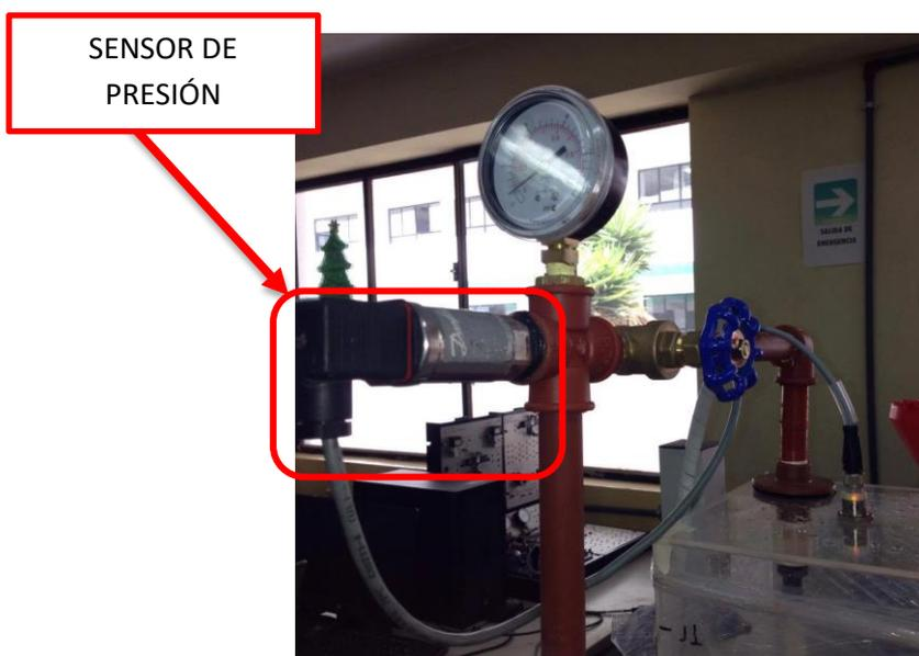
**Figura.85: Ubicación del sensor de presión.**
