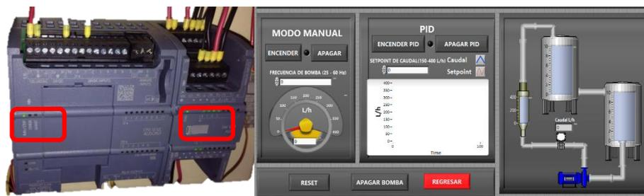
**Figura.135: PLC y HMI conectado y funcionando.**
