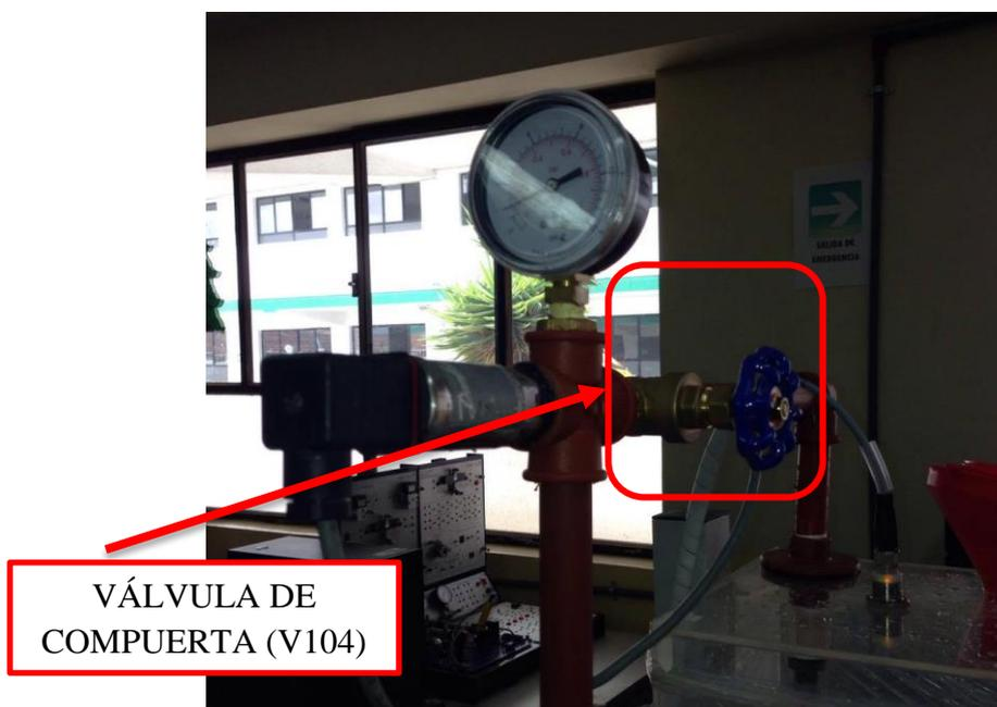
**Figura.92: Ubicación de la válvula de compuerta.**
