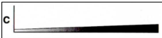
Figura 23 Patrón de falla C. (Curva de desgaste).
