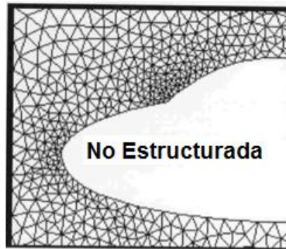
Figura 16 Malla no estructurada
