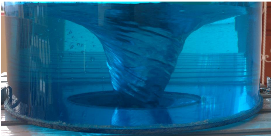
Figura 131 Vista frontal real de fracción de volumen de agua
