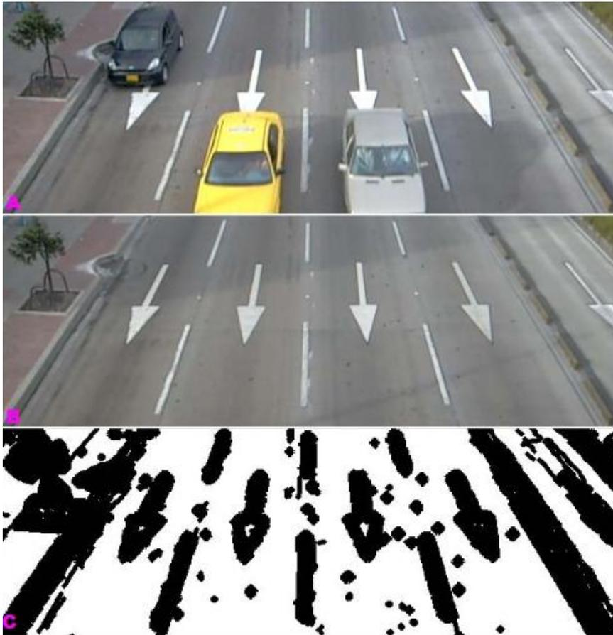
**Figura 7. Ejemplo de mascara de fondo (B) de una imagen (A) con el fondo calculado por medida aumentada (B)**
