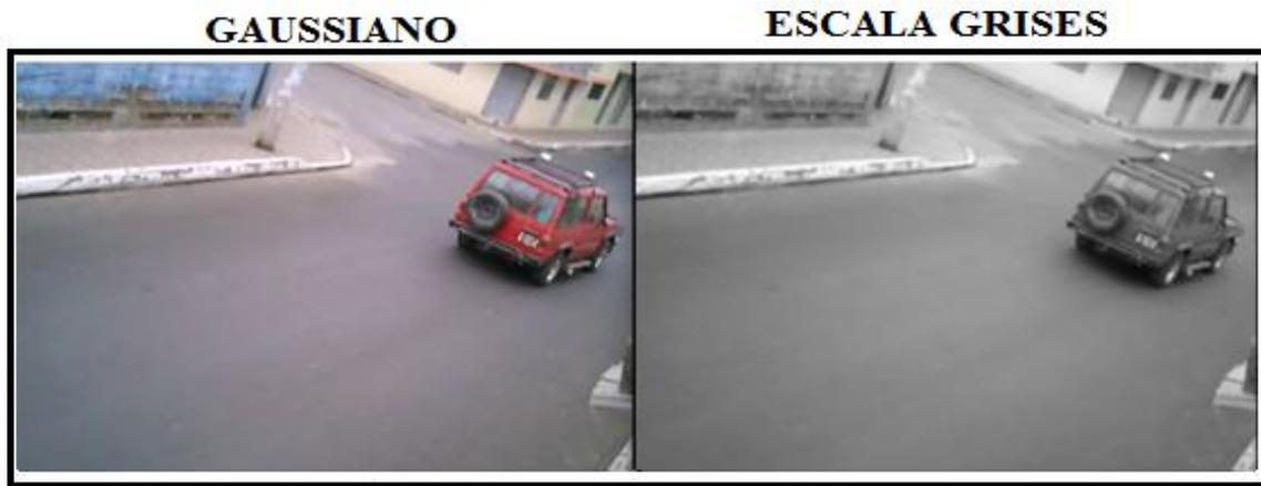
**Figura 48. Transformación de la imagen de filtro gaussiano a escala de grises**
