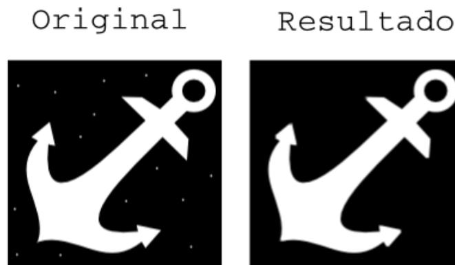
**Figura 34. Ejemplo de una imagen aplicando Opening**
