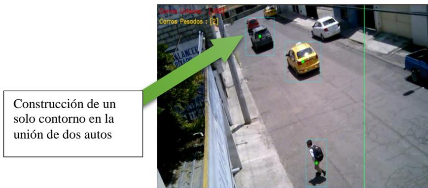
**Figura 66. Construcción de un solo contorno en vehículos que circulan muy cerca**
