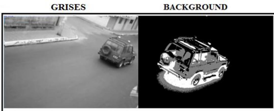
**Figura 49. Transformación de la imagen en nivel de grises a Background Subtraction**
