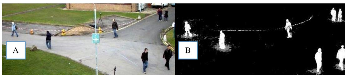
**Figura 28. (A) Imagen original (B) Imagen aplicada la sustracción de Fondo MOG2**
