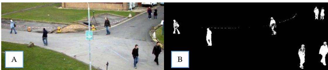
**Figura 27. (A)Imagen original (B) Imagen aplicada la sustracción de Fondo MOG**
