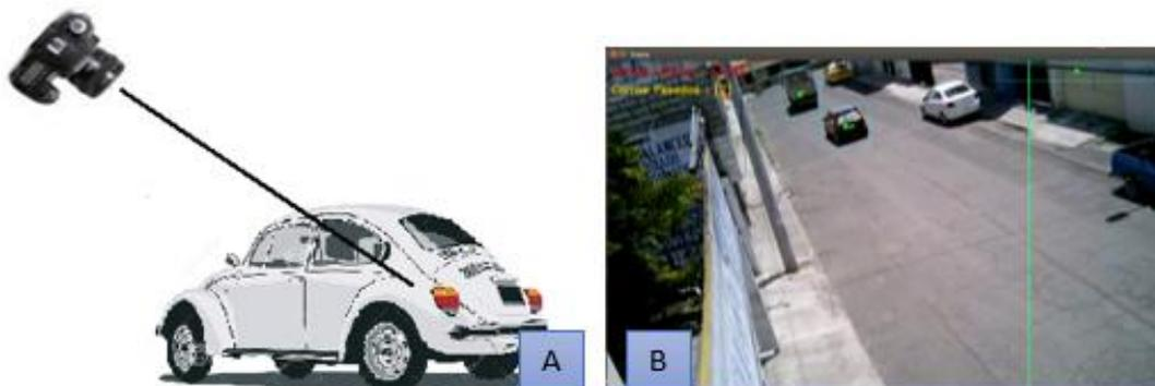
**Figura 46. Enfoque de la cámara lateral-trasera al vehículo(A), discriminación de un carro liviano – pesado (B)**
