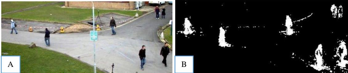
**Figura 29. (A)Imagen original (B) Imagen aplicada la sustracción de Fondo GMG**
