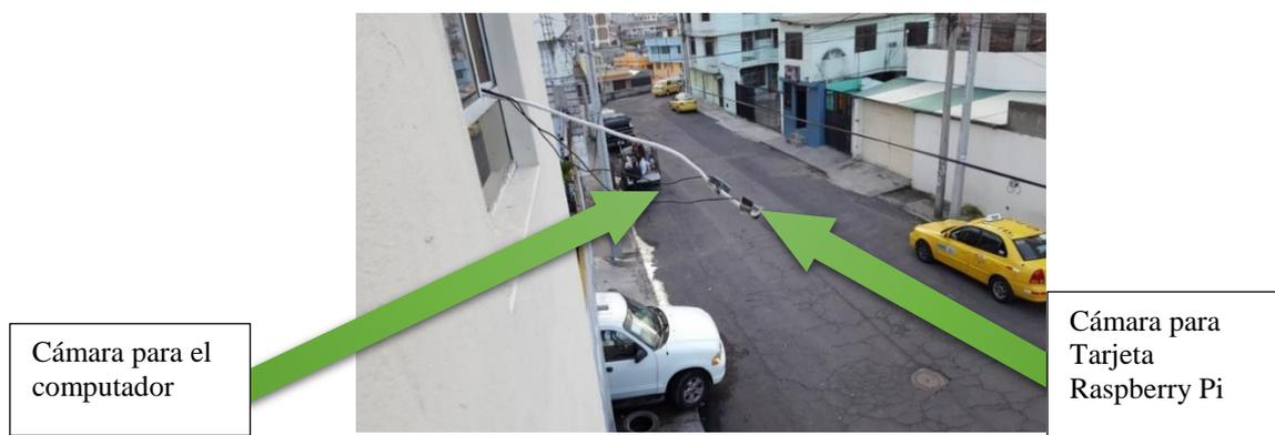
**Figura 64. Identificación de las cámaras independientes tanto para la Tarjeta como para la Pc**
