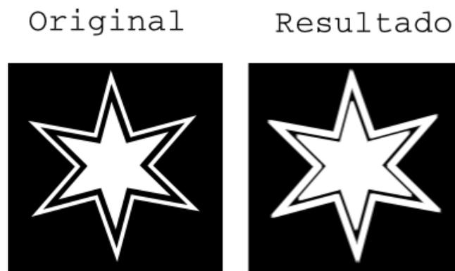
**Figura 32.** *Ejemplo de una imagen aplicando Dilation*
