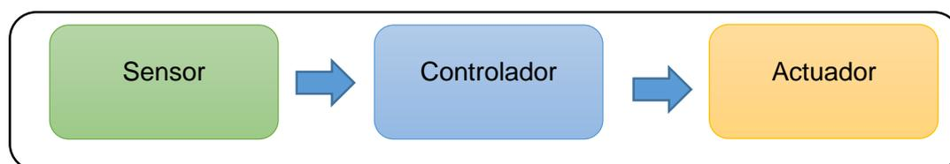
**Figura 1 Componentes básicos de un sistema domótico.**
