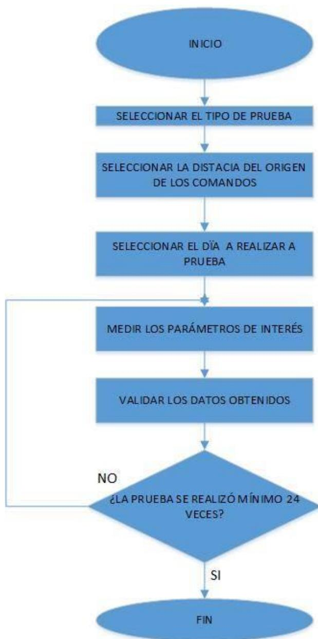
**Figura 28 Diagrama de flujo para validar las mediciones**
