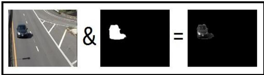
**Figura 16:** Segmentación de la imagen procesada
