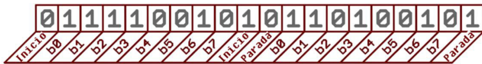
Figura 33 Envío de dos bytes, comunicación serial
