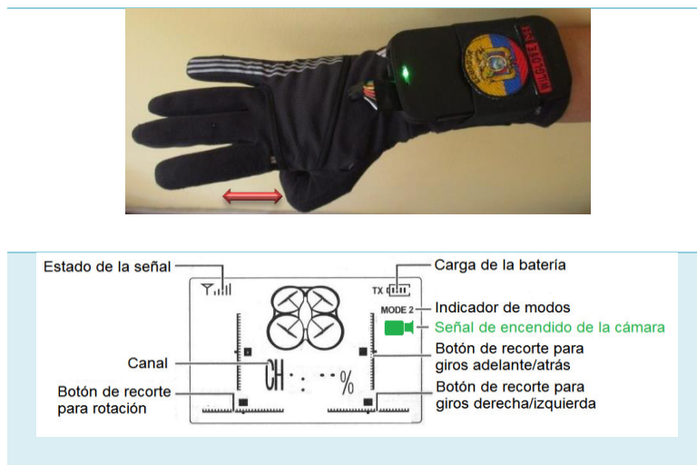
Figura 83 ON/OFF de video, pantalla de control del Dron
