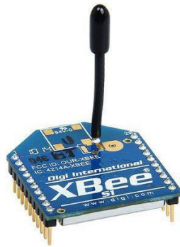
Figura 71 Módulo XBee S1 (izquierda)
