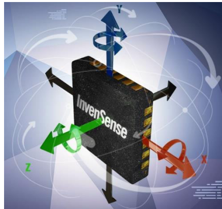
Figura 16 Movimiento del giroscopio con respecto a los ejes de rotación X, Y, Z
