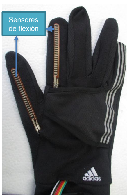
Figura 111 Ubicación de los sensores de flexión en el guante
