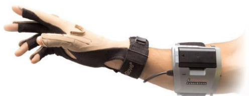
Figura 4 CyberGlove, con sensores magnéticos
