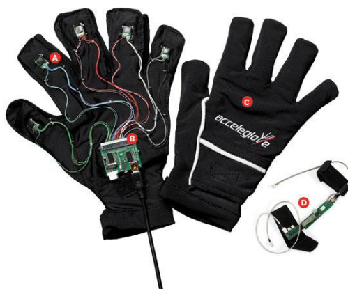
Figura 5 AcceleGlove, con acelerómetros
