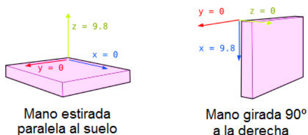
Figura 86 Gravedad en los ejes del acelerómetro según la inclinación
