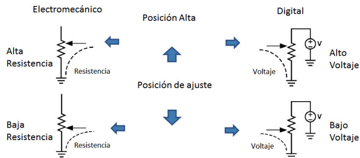
Figura 23 Funcionamiento de los Potenciómetros Electromecánicos y Digitales
