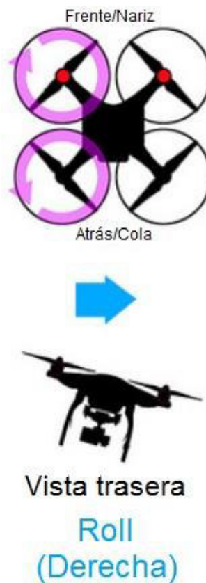
Figura 124 Compensación de los motores del Dron en roll
