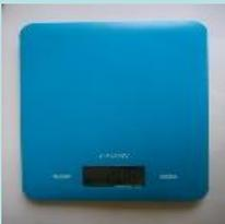
7. Balanza electrónica.- Utilizada para el pesaje del explosivo ANFO, en el prototipo será de 150 [g], su capacidad máxima de pesaje es de 5 [Kg]
