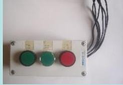
8. Botones de control.- Para el control manual se colocó tres botones los mismos que son INICIO, MANTENIMIENTO Y PARO, adicional a este se colocó un botón de control de la compuerta de dosificado, los niveles de tensión para su funcionamiento es de 24 [VDC].
