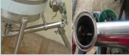
4. Tornillo sin fin.- Encargado de realizar la mezcla proveniente del silo de mezcla, sus dimensiones son 80 [cm] de largo x 5 [cm] de diámetro inclinación 45°
