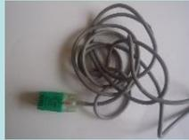
9. Sensor de barrera.- El sensor tiene el objeto de accionar el motor con el cual funcionará la banda transportadora, trasladando del área de sellado al área de carga, su alimentación es de 24 [VDC].
