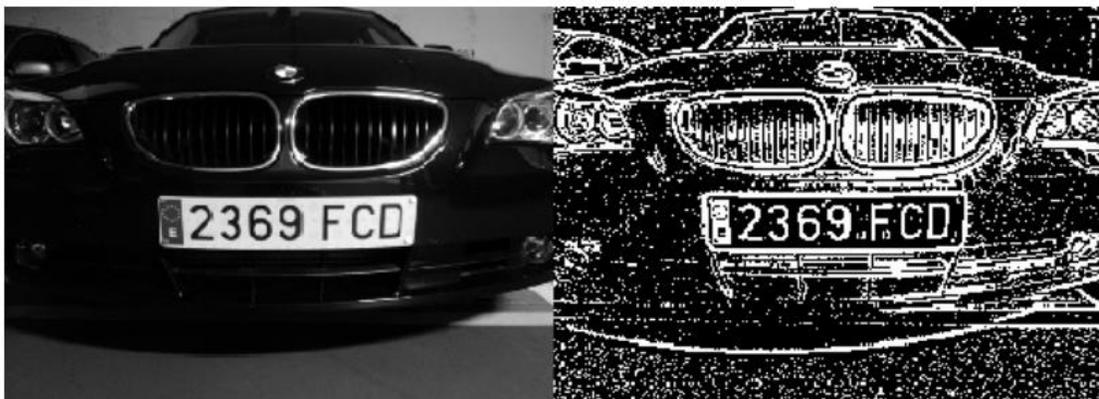
**Figura 7:** Ejemplo de la conversión de una imagen en escala de grises a una imagen binarizada.
