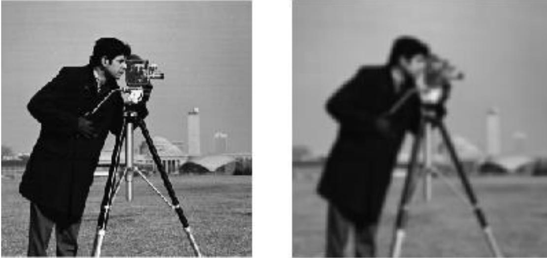
**Figura 8:** Ejemplo de una imagen que ha sido filtrada con un filtro Gaussiano, a la izquierda la imagen original y a la derecha el resultado del filtro para un  $\sigma=2$ .
