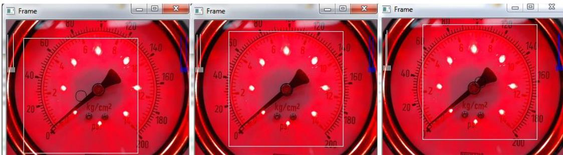
**Figura 56:** Secuencia de imágenes del entrenamiento de la RNA que reconoce la escala del manómetro.
