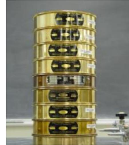
Tomando en cuenta el peso total y los pesos retenidos, se procede a realizar la curva granulométrica, con los valores de porcentaje retenido que cada diámetro ha obtenido. La curva granulométrica permite visualizar la tendencia homogénea o heterogénea que tienen los tamaños de grano (diámetros) de las partículas.
