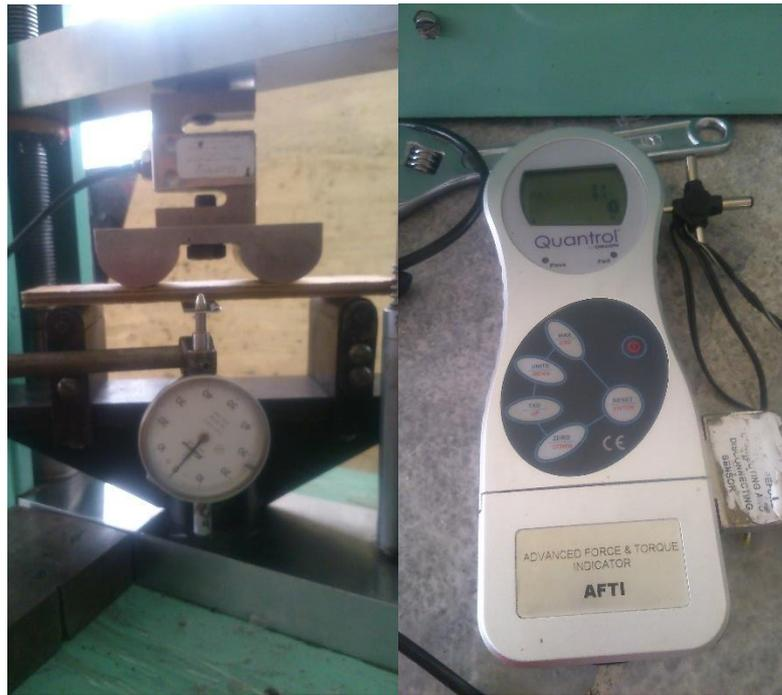
**Figura 69 Medidor de fuerza digital**
