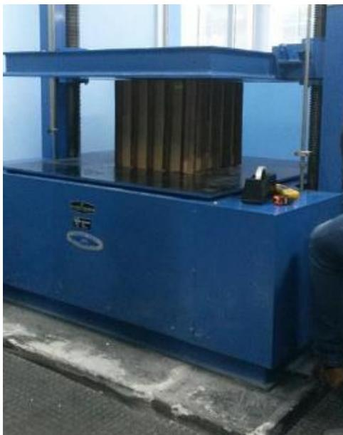
**Figura 104 Módulo del asiento ensayado en compresión**
