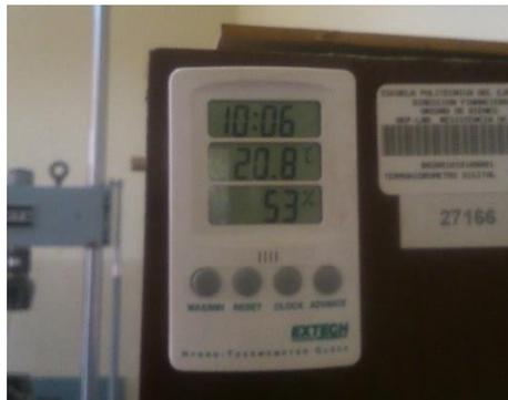
**Figura 68 Hora – temperatura - humedad relativa del ambiente en ensayos de flexión**
