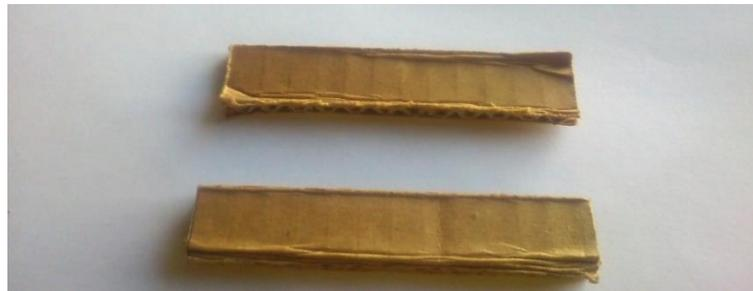
**Figura 46** Probeta C250 y DP350 ensayada vista superior
