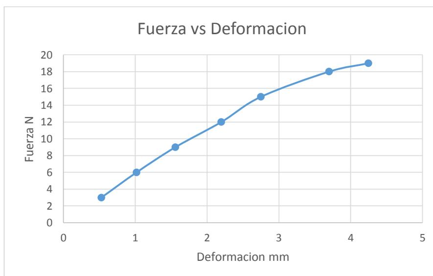
**Figura 79 Fuerza vs Deformación C250 en sentido transversal - 1 punto**
