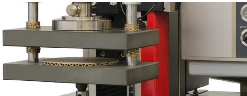
**Figura 8 Máquina y Probeta de Aplastamiento Plano en Cartón Corrugado**
