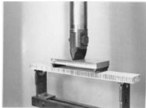
**Figura 59 Ensayo de flexión con 2 cargas uniformes**
