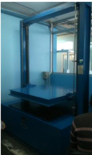
**Figura 100 Máquina de compresión CO702D –Tester Sangyo de los laboratorios del INEN**
