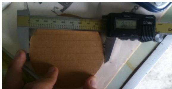
**Figura 41 Probeta de aplastamiento plano**
