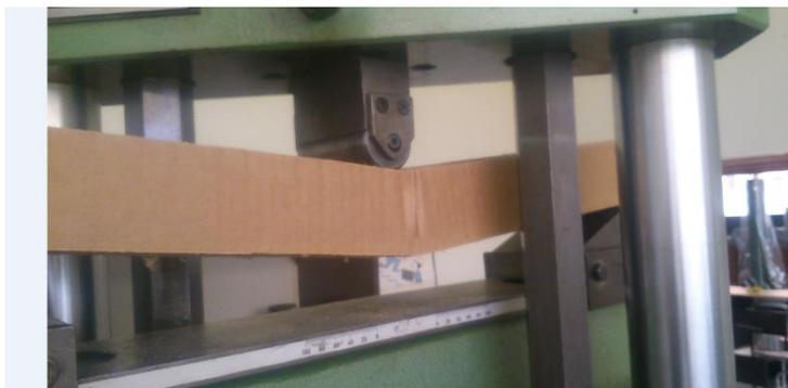
**Figura 108** Viga que ha fallado con una carga de flexión
