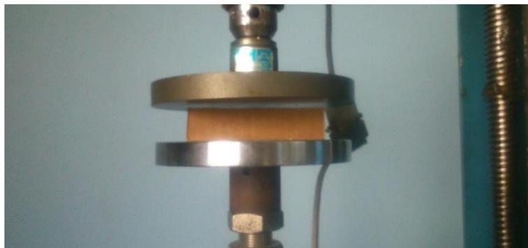
**Figura 44 Probeta C250 en ensayo de compresión de borde**
