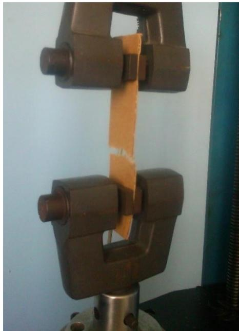
**Figura 56** Falla por tracción (sentido de máquina)
