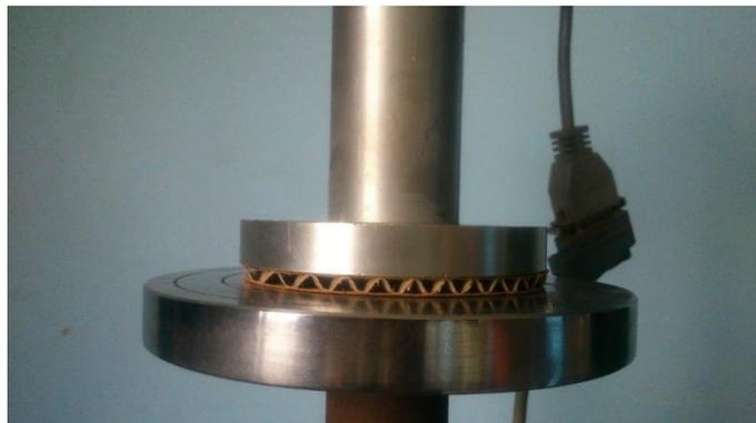
**Figura 42** Probeta de aplastamiento ensayándose
