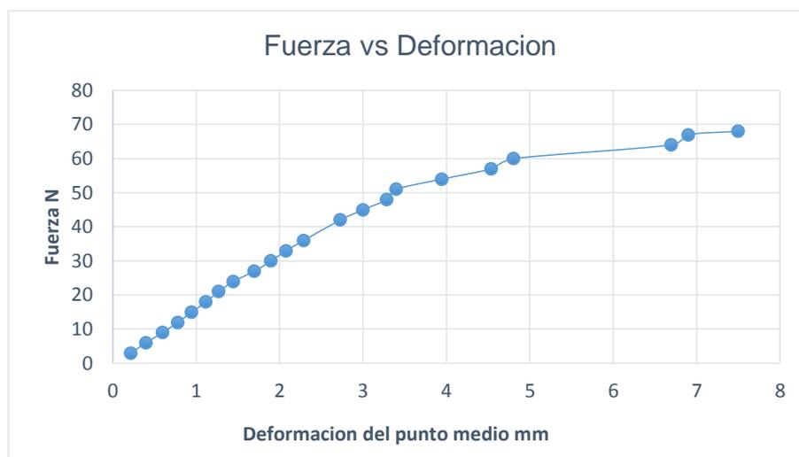
**Figura 72 Fuerza vs Deformación DP350 sentido transversal - 2 puntos**
