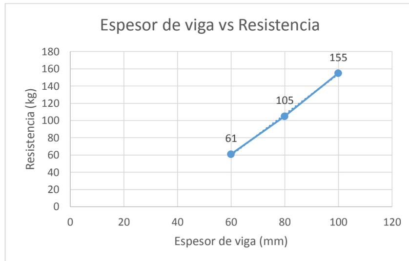
**Figura 109 . Espesor de viga vs resistencia en a la flexión de las vigas analizadas**
