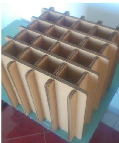
**Figura 92 Zona de asiento de silla hecha con 2 láminas ranuradas por cada pared**
