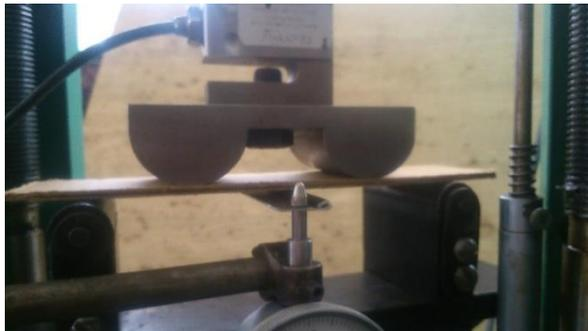
**Figura 70 Ensayo de flexión dos puntos uniformes**
