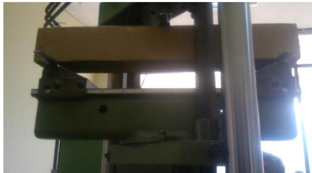
**Figura 107 : Prueba de flexión de vigas de cartón**
