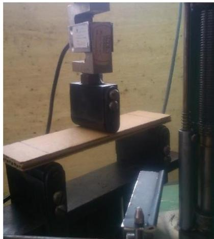
**Figura 71 Ensayo de flexión carga puntual en el centro**
