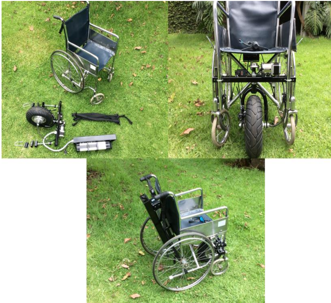
Figura 140. Montaje del módulo mecatrónico.
