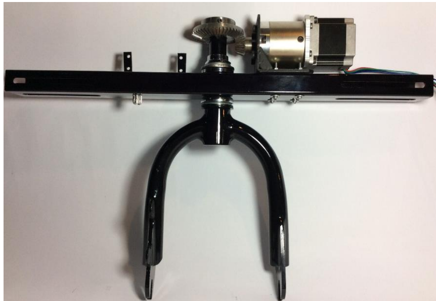
Figura 134. Acople de piñón y engrane.
