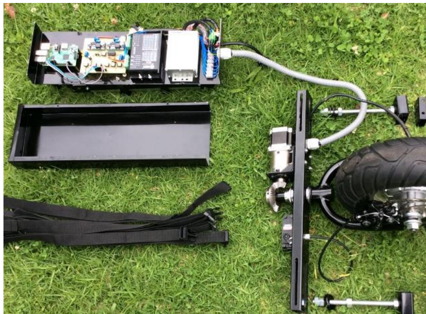
Figura 144. Cableado de motores.
