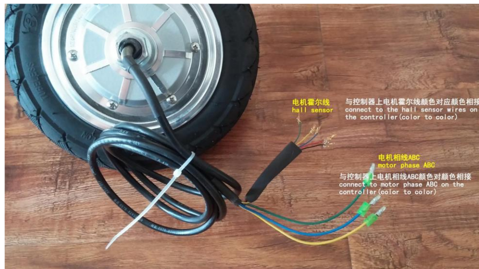
Figura 87. Cables de conexión del motor DC Brushless.
