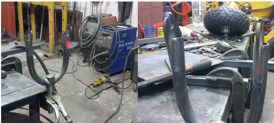
Figura 124. Soldadura de sujetadores.
