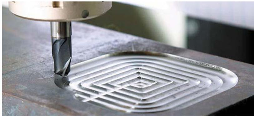
**Figura 1.** Herramienta para desbaste de metal.
