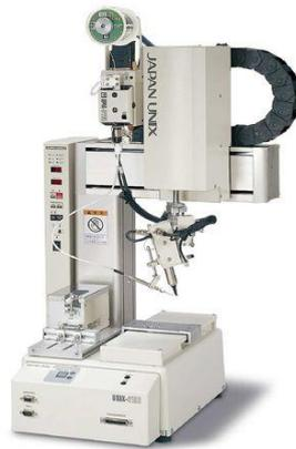
**Figura 26** Robot cartesiano de 4 ejes de soldadura de mesa
