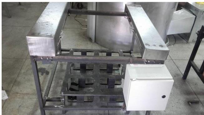
**Figura 79** Colocación protecciones y paneles de control
