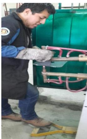
**Figura 73** Soldadura por punto
