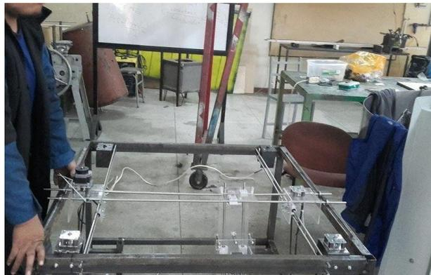
**Figura 78** Colocación de rodamientos lineales en soportes de acrílico
