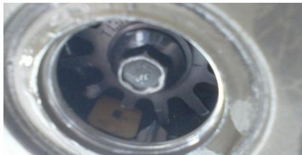
Figura 82: Sensor CKP con diente disminuido.
