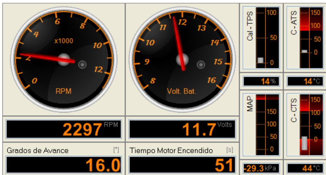
Figura 101: Estado del motor en arranque en frío.
