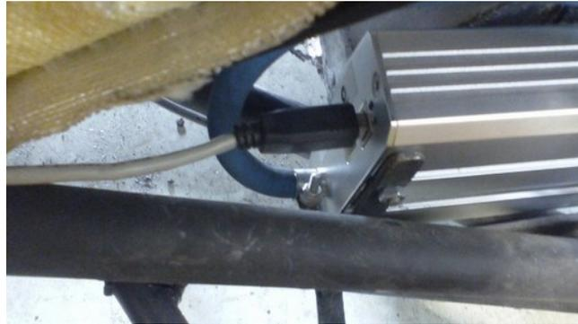
Figura 67: Cable USB conectado a la ECU.
