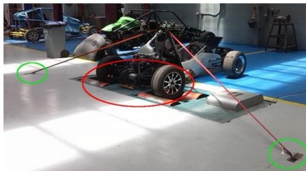
Figura 104: Vehículo asegurado para prueba de potencia.
