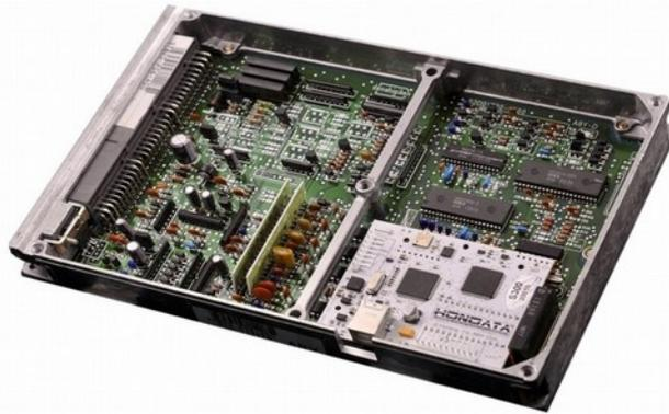
Figura 52: Adaptador s300 en centralita.
