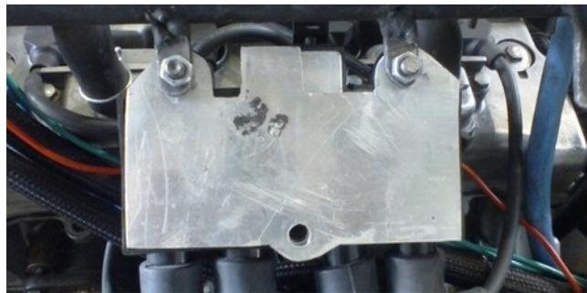
Figura 86: Placa de aluminio para refrigeración.
