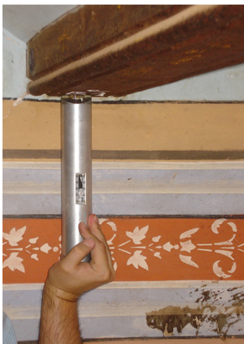
Figura 22 Empleo del penetrómetro Pilodyn 6J. Fuente: (Maldonado, Gonzales, Arriaga, & Herrero, 2009)
