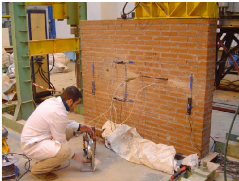
Figura 26 Ensayo de gato plano simple Fuente: (Lombillo, Villegas, Silio, Hoppe, & GTED-UC, 2007)
