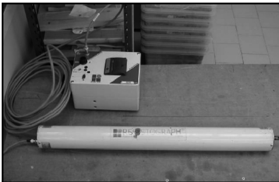
Figura 23 Resistógrafo. Fuente: (Álvarez, Basterra, Sanz, & Rello, 2007)
