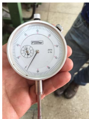
Figura 39. Comparador de reloj utilizado en ensayos.
