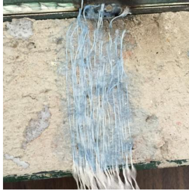
Figura 62. Fibras PET empleando Griffon (PVC) para el pegado.
