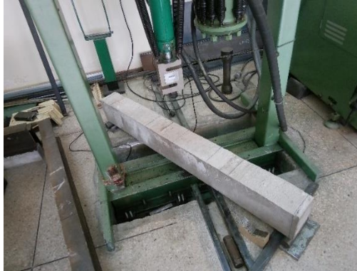
Figura 58. Viga colocada sobre rodillos de apoyo.
