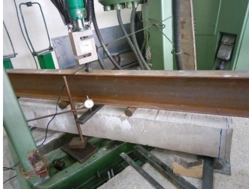
Figura 61. Comparador de reloj ubicado sobre viga de hormigón.
