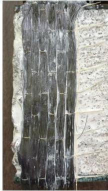
Figura 66. Fibras de carbono adherido a hormigón por medio de Sikadur 301.
