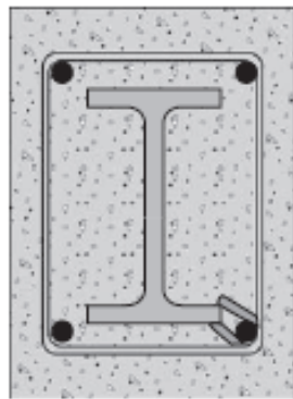
Figura 1. Viga compuesta (sección encerrada)
