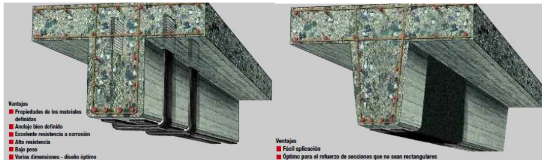
Figura 8. Refuerzo de viga de hormigón a cortante
