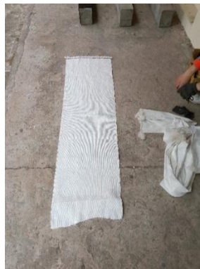
Figura 46. Corte de fibra PET en medidas establecidas.
