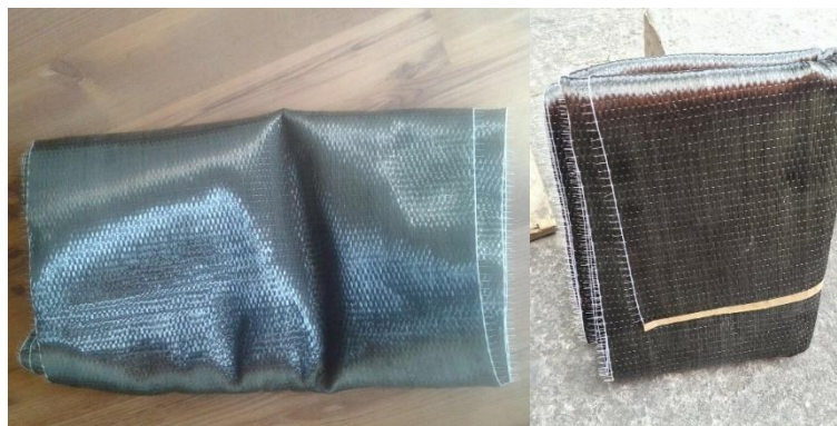
Figura 27. Tramo de 10 m de SikaWrap 300C.
