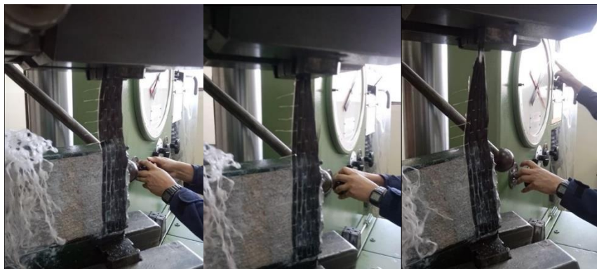
Figura 67. Ensayo de tensión Fibra de carbono – Sikadur 301 – Hormigón.
