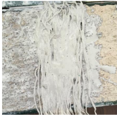
Figura 64. Fibras PET empleando Sikadur 301 para el pegado.
