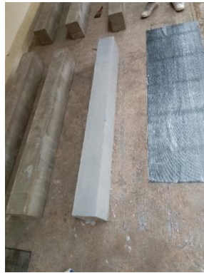
Figura 54. Impregnación de pegamento Sikadur 301 sobre vigas.
