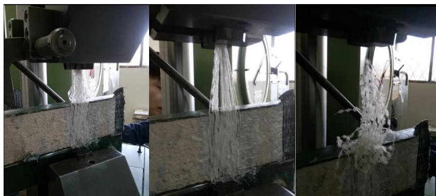
Figura 65. Ensayo de tensión Fibra PET – Sikadur 301 - Hormigón
