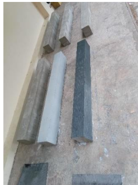
Figura 55. Colocación de refuerzos de fibras sobre vigas.
