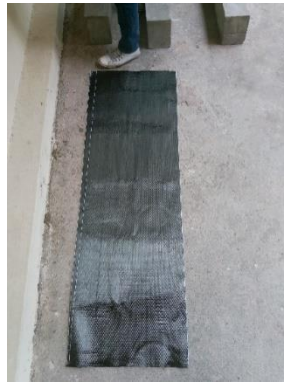
Figura 51. Corte de fibra de carbono en medidas establecidas.
