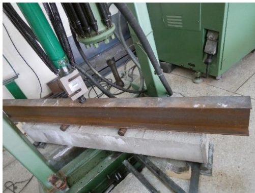
Figura 60. Viga de hormigón con precarga (viga de acero).
