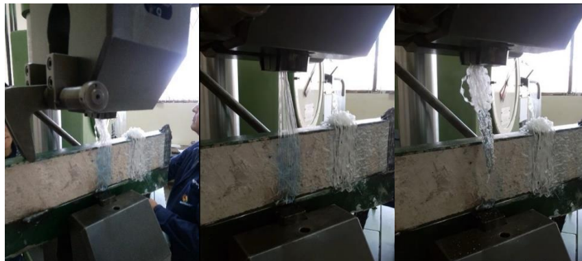
Figura 63. Ensayo de tensión Fibra PET – Griffon – Hormigón.
