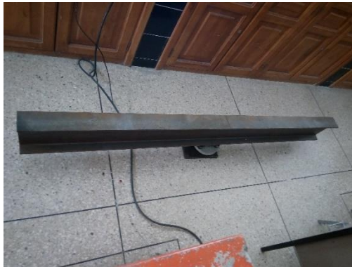
Figura 59. Pesaje de viga de acero (precarga) por medio de celda de carga.
