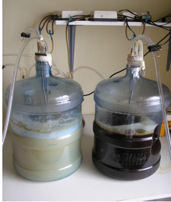
Figura 2. 6 Producción de biofertilizante a partir de Azotobacter spp a escala diez litros en Caldo Pikovskaya modificado (izquierda) y Caldo alternativo melaza (derecha). (Cristina Echeverría; Quito, octubre 2006)
