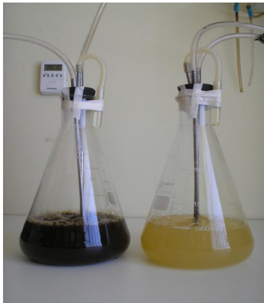
Figura 2.3 Inóculos a escala de laboratorio de Azotobacter spp en Caldo Alternativo melaza (izquierda) y Caldo Pikovskaya modificado (derecha). (Cristina Echeverría; Quito, abril 2006)
