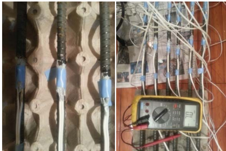
Figura 111: Ubicación de Strain Gauges en acero figurado
