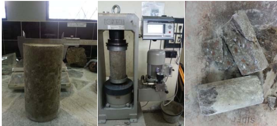
Figura 106: Cilindros fracturados en la máquina de ensayos de compresión
