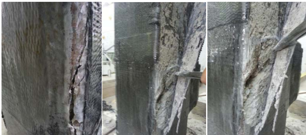
Figura 154: Falla en el nudo
