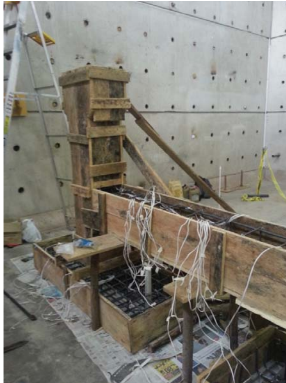
Figura 113: Encofrado de la probeta.
