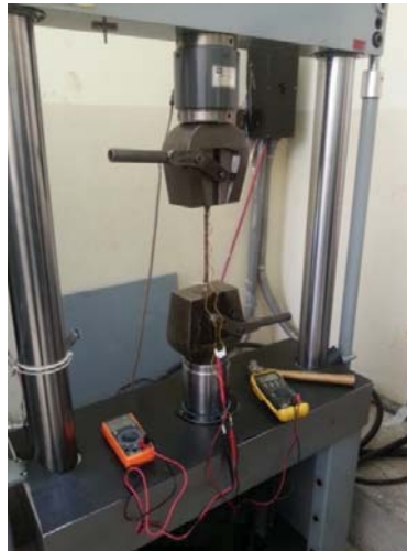
Figura 107: Ensayo de tracción de varillas con galgas extensiométricas (Strain gauges)
