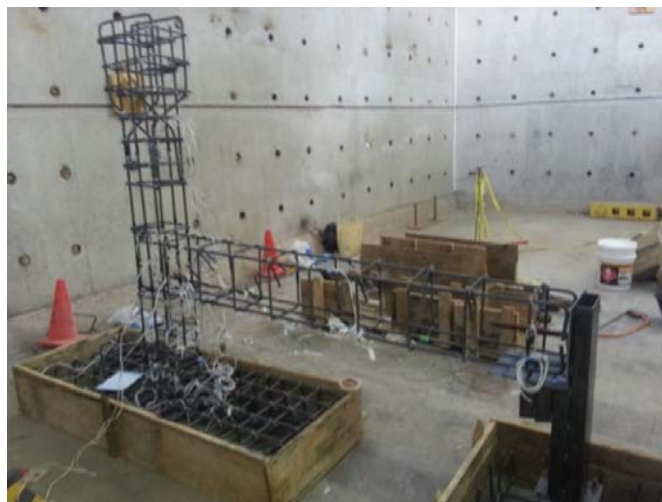
Figura 112: Armado de la probeta (Ubicación en sitio del ensayo)
