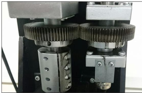
**Figura 2 Sistema de engranajes para transmisión de torque al brazo**
