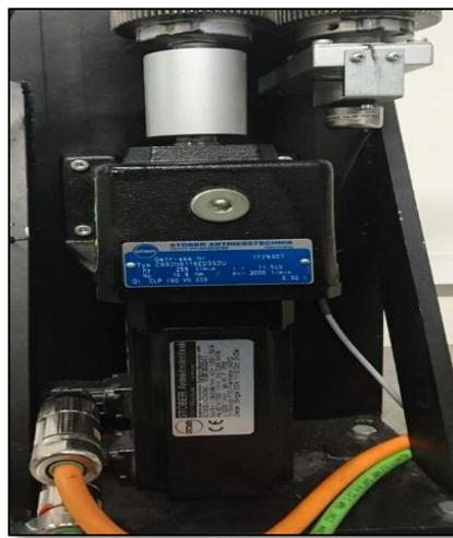
**Figura 6 Servomotor ED302U, sobre soporte metálico**
