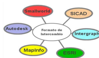
Figura 4 Topología estrella para implementación de interfaces
