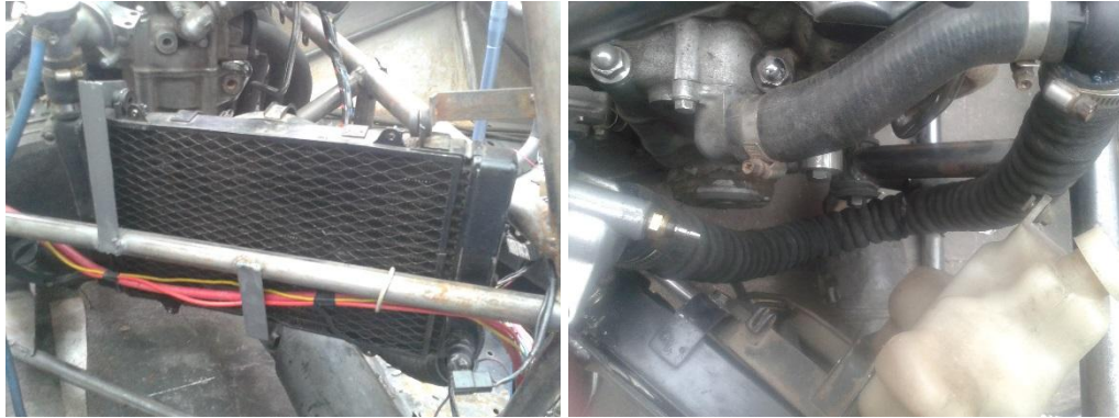
Figura 86 Fijación del radiador y cambio de mangueras de agua
