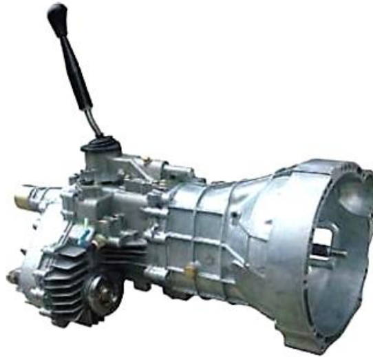
Figura 29 Palanca de cambios accionando directamente
