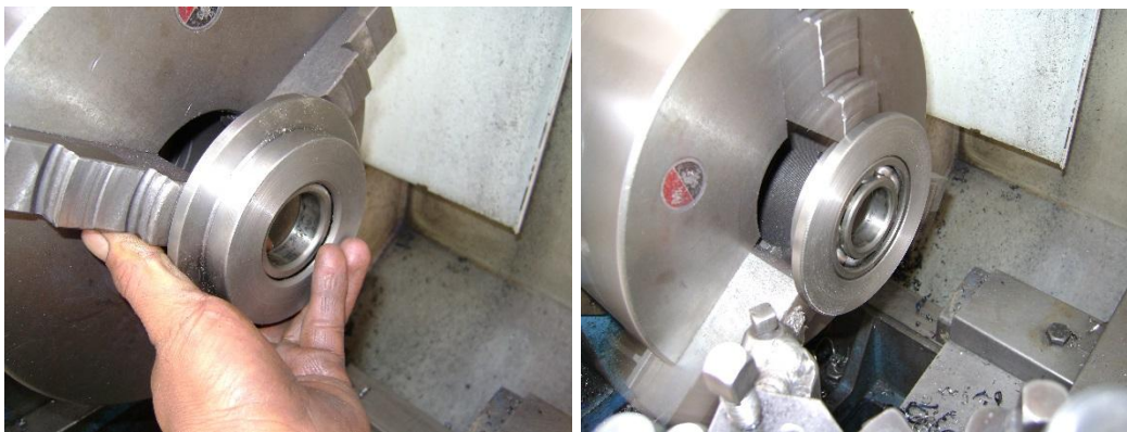
Figura 102 Proceso de torneado de los soportes de brida
