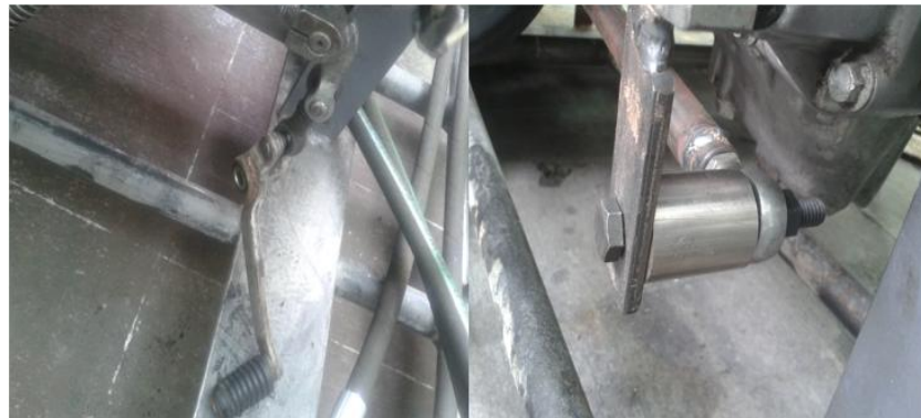
Figura 119 Pedal de entrada de los cambios modificado para el vehículo
