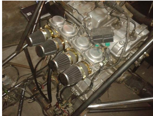
Figura 88 Montaje del carburador y filtros de aire.
