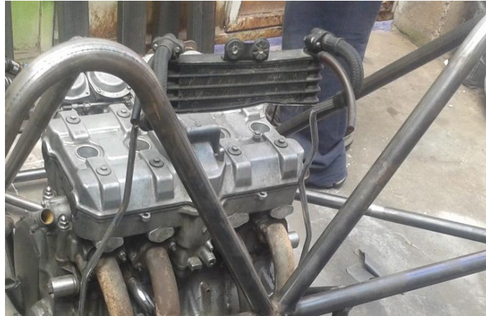
Figura 90 Fijación del radiador de aceite
