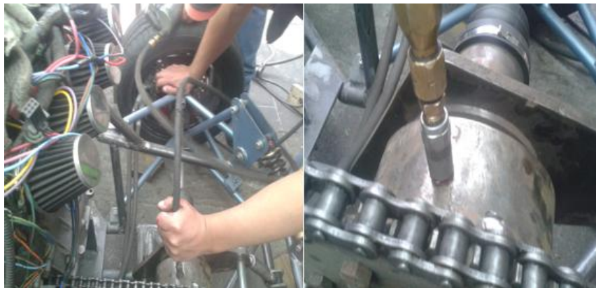
Figura 117 Lubricación del diferencial
