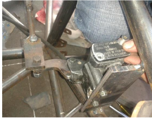
Figura 120 Adaptación de la bomba de embrague a pedal
