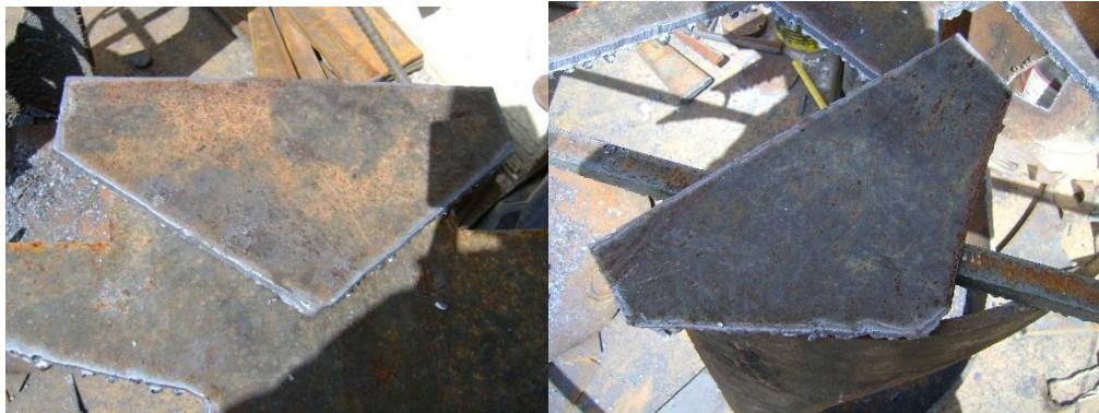
Figura 96 Corte de los soportes del diferencial
