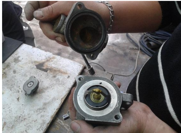
Figura 94 Adaptación de un termostato nuevo
