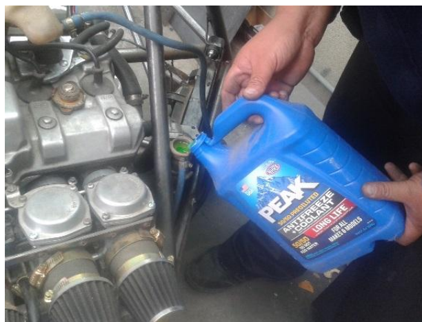
Figura 95 Llenado de refrigerante en el radiador
