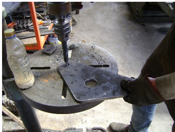
Figura 97 Perforación de los agujeros laterales
