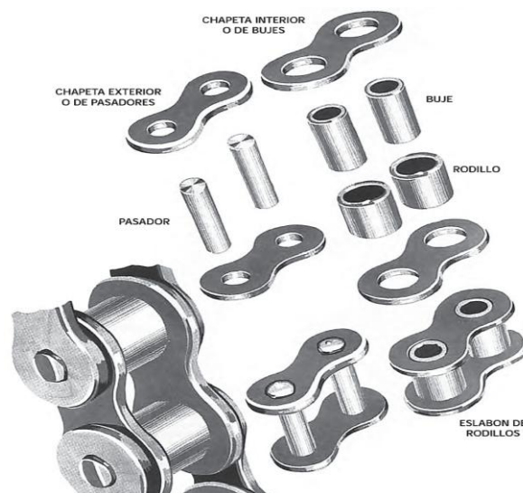
Figura 48 Componentes básicos de una cadena de rodillos
