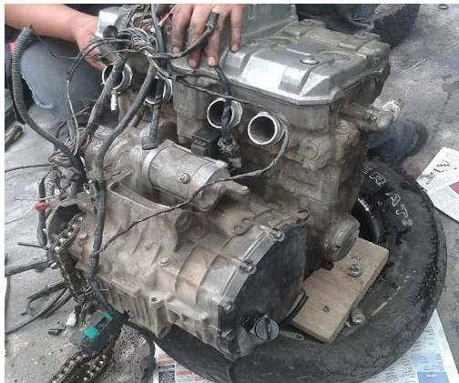
Figura 80 Desmontaje del motor
