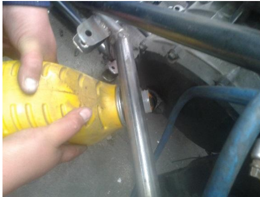
Figura 92 Llenado de aceite con aceite SAE 20 W 50
