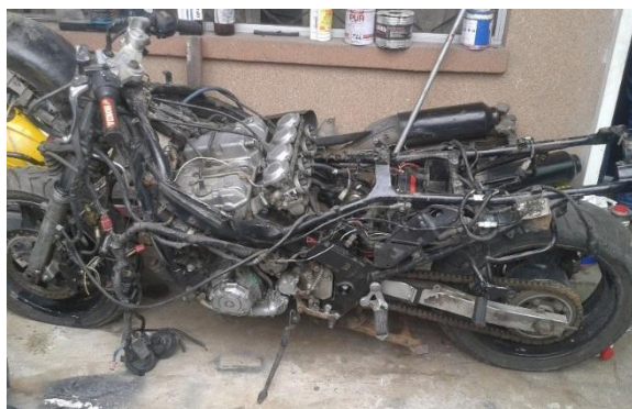
Figura 79 Desmontaje de la carrocería
