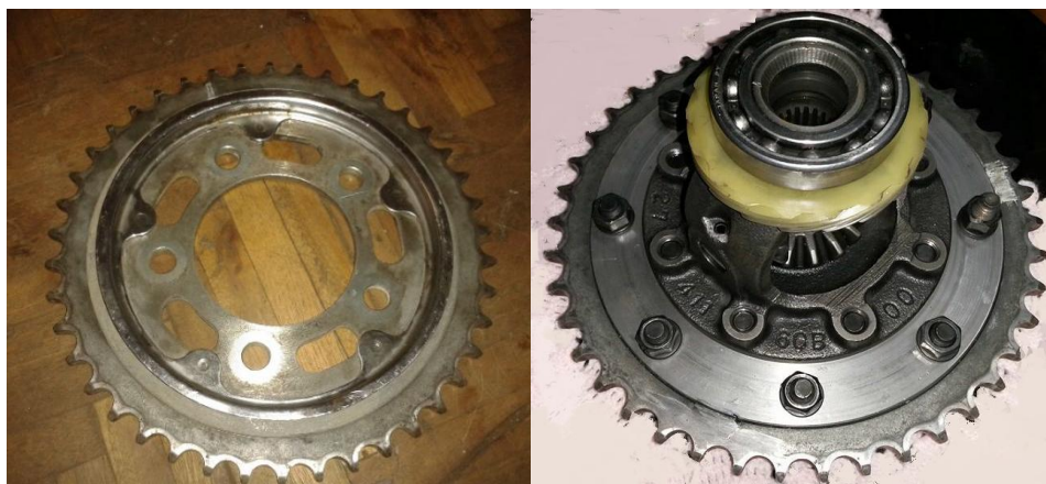
Figura 101 Junta para la corona con el diferencial
