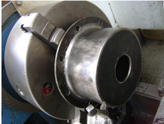
Figura 100 Torneado final a la carcasa o cárter del diferencial
