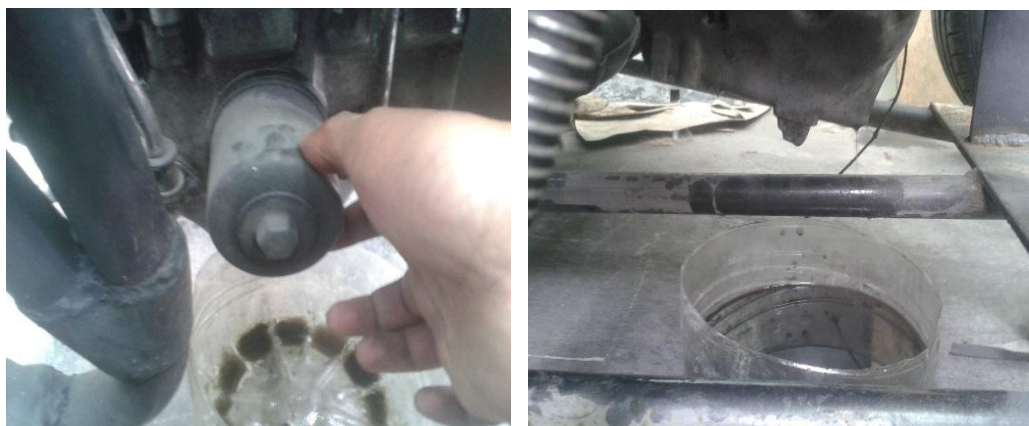
Figura 91 Drenaje del aceite y desmontaje del filtro de aceite
