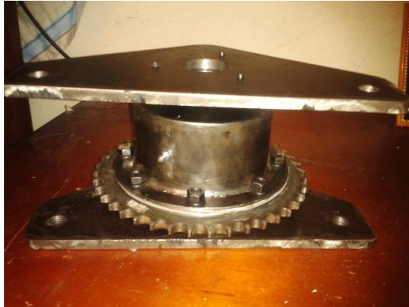
Figura 107 Soporte del diferencial ensamblado
