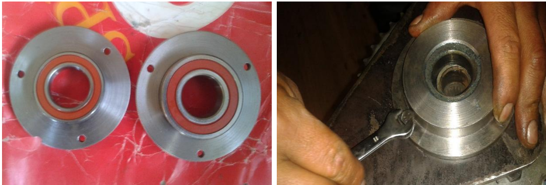
Figura 104 Colocación de los rodamientos y ensamble de los soportes
