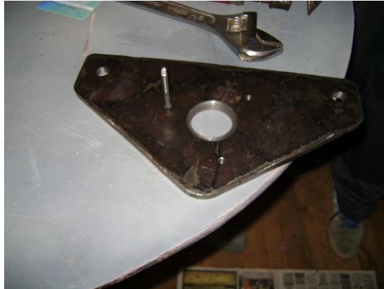
Figura 98 Perforado y machueleado para los soportes de brida
