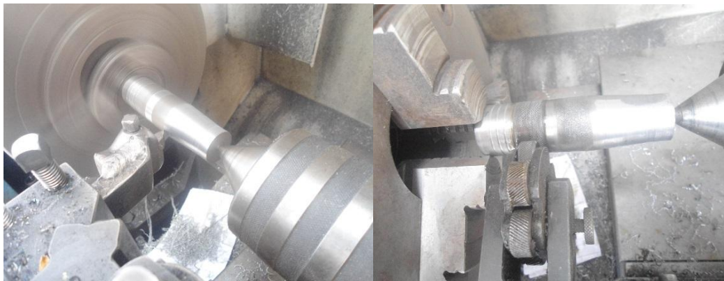
Figura 113 Construcción del pomo para la palanca de cambios
