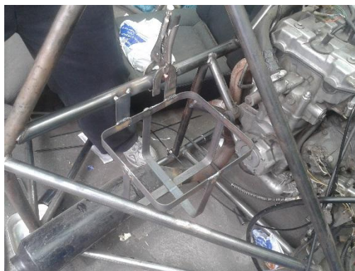
Figura 89 Soporte para el tanque de combustible
