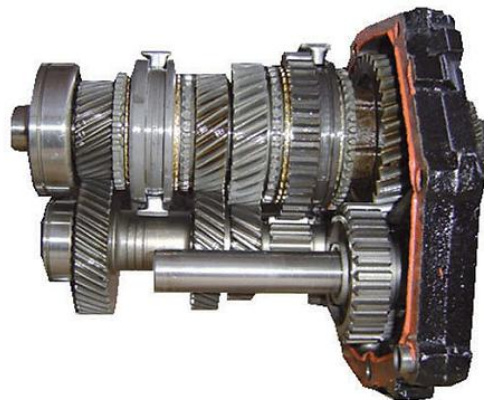
Figura 25 Trenes de engranajes de dentado helicoidal y recto
