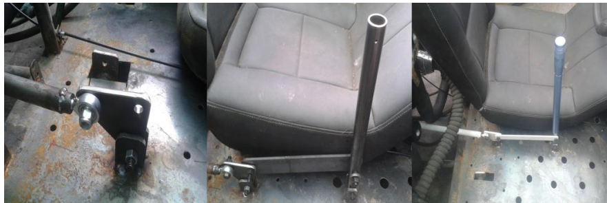
Figura 121 Primer varillaje de los cambios
