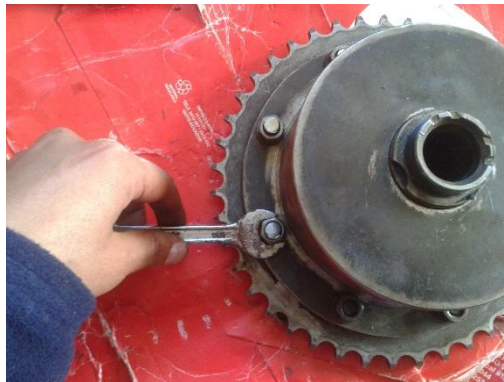
Figura 106 Ensamble del cárter del diferencial a la corona
