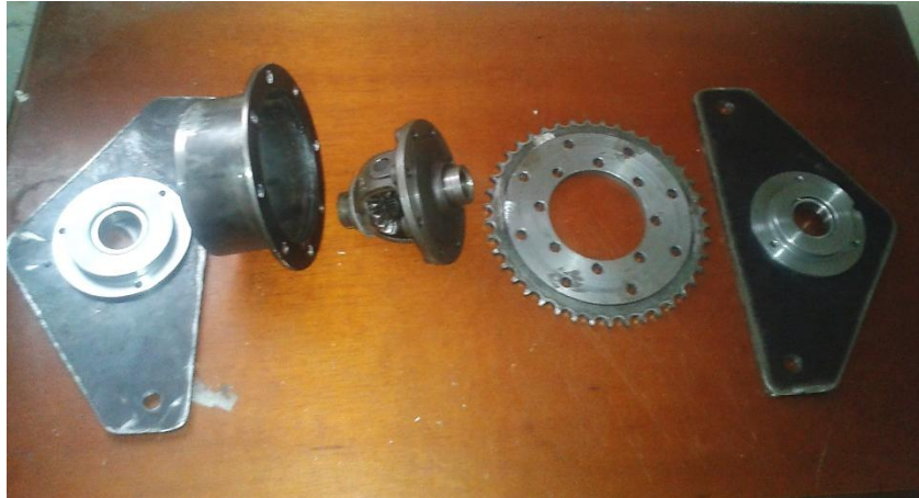
Figura 105 Componentes del soporte para el diferencial
