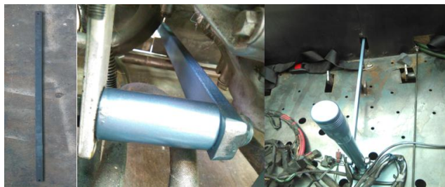
Figura 122 Varillaje final de los cambios
