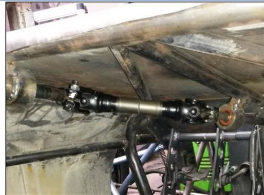
Colocamos las bases del eje de fijación del volante en el eje del volante y soldamos las bases en la mejor posición del volante.
