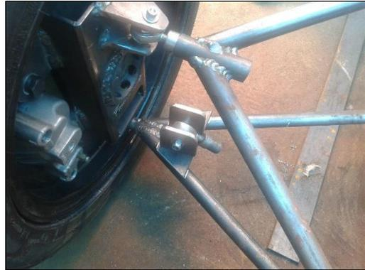
Instalamos las Push-bar y colocamos los neumáticos. Y las suspensiones delanteras independientes están listas para probarlas.
