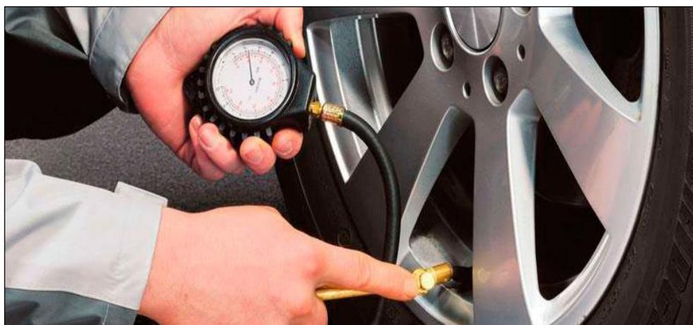
**Figura 130. Comprobando la presión de inflado del neumático.**
