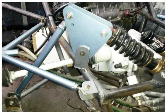
**Figura 83. Rockers del sistema de suspensión delantera y posterior.**
