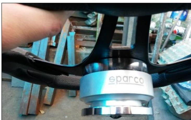
**Figura 132. Acople rápido para el volante de marca SPARCO.**
