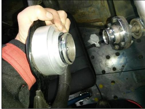
**Figura 100. Acople rápido para volante Sparco**
