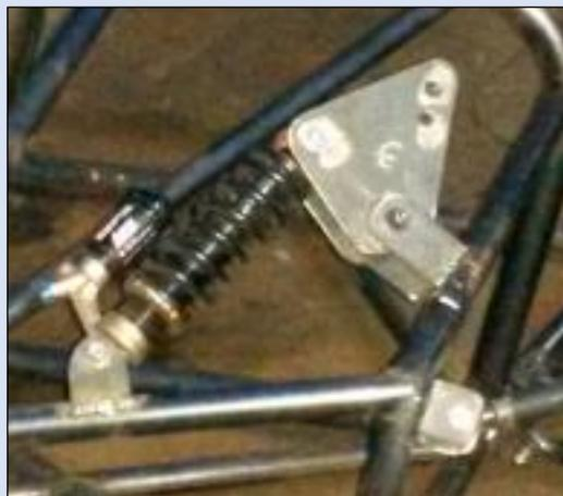
Al tener todo listo soldamos las bases, la del rocker y la del amortiguador en el bastidor.
