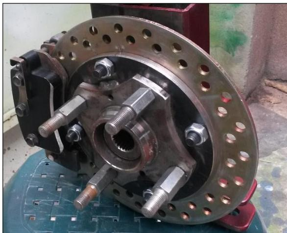
**Figura 136. Conjunto armado mangueta.**
