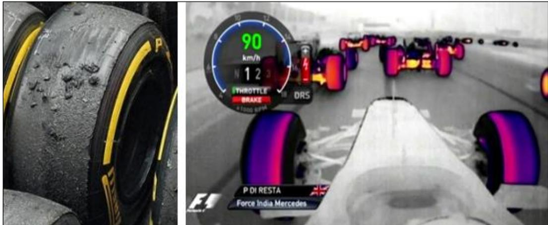
**Figura 15. Influencia del exceso de temperatura en los neumáticos.**
