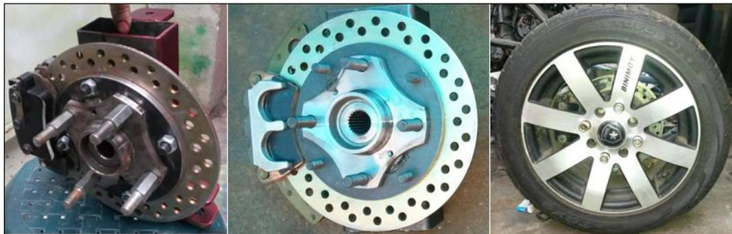
**Figura 106. Conjunto armado con los discos de frenos**
