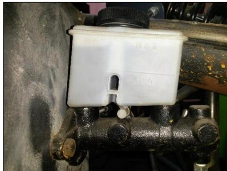
**Figura 102. Bomba de frenos**
