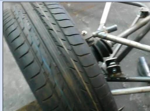
Instalamos las Push-bar en sus respectivos puntos de anclaje y colocamos los neumáticos. Ahora ya las suspensiones posteriores independientes están listas para probarlas.
