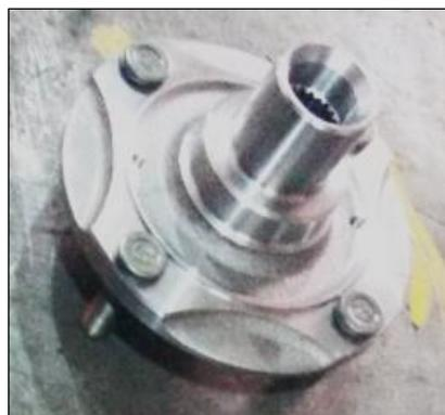
**Figura 77. Manzana del Suzuki Forsa II.**
