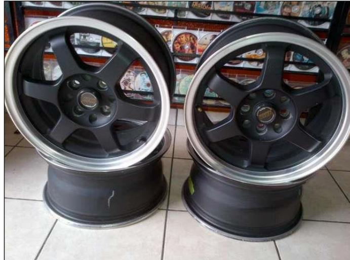
**Figura 76. Aros de aleación de Magnesio - Una sola pieza de fundición**
