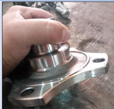
**MECANIZADO DEL ACOPLE PARA LA BASE DEL DISCO DE FRENOS**
