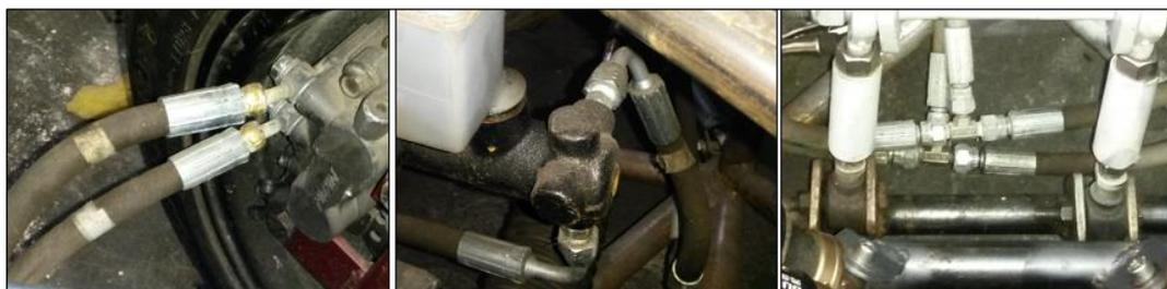
**Figura 103. Cañerías de alta presión para el sistema de frenos**
