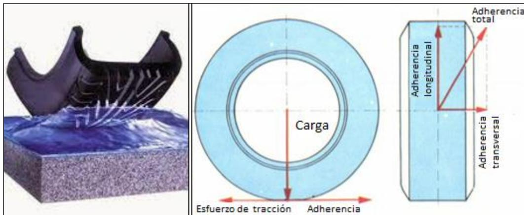
**Figura 11. Esfuerzos sobre un neumático en superficie con agua.**
